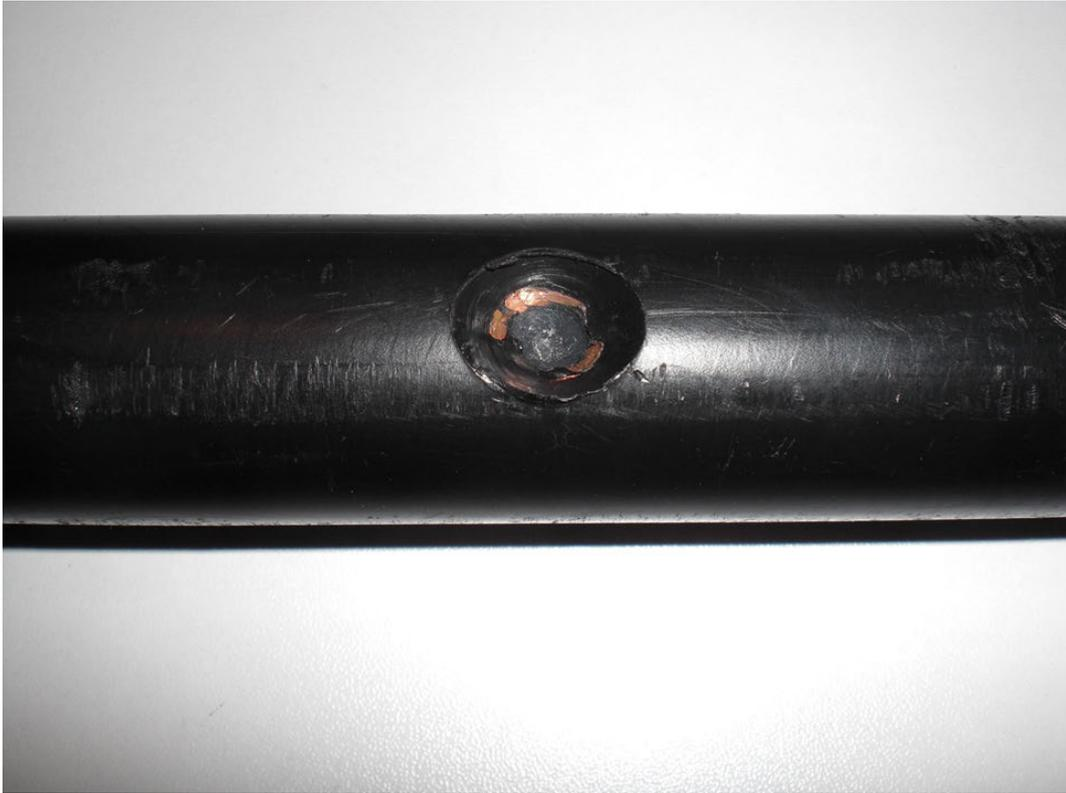
Abbildung 10-11: Dritte Anordnung ( $C_P = 3$ ); Kabelprüfling mit einer Kegelbohrung
