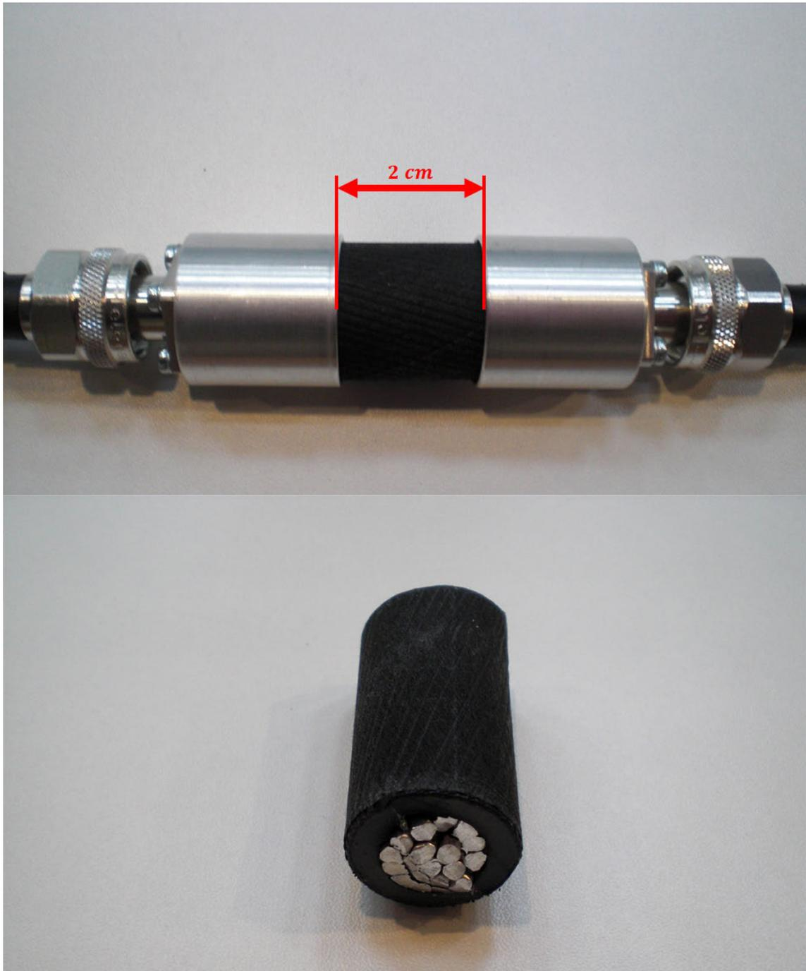
**Abbildung 10-8: Lokale Fehlstelle; Vollständig unterbrochener Schirm eines Kabelstücks**
