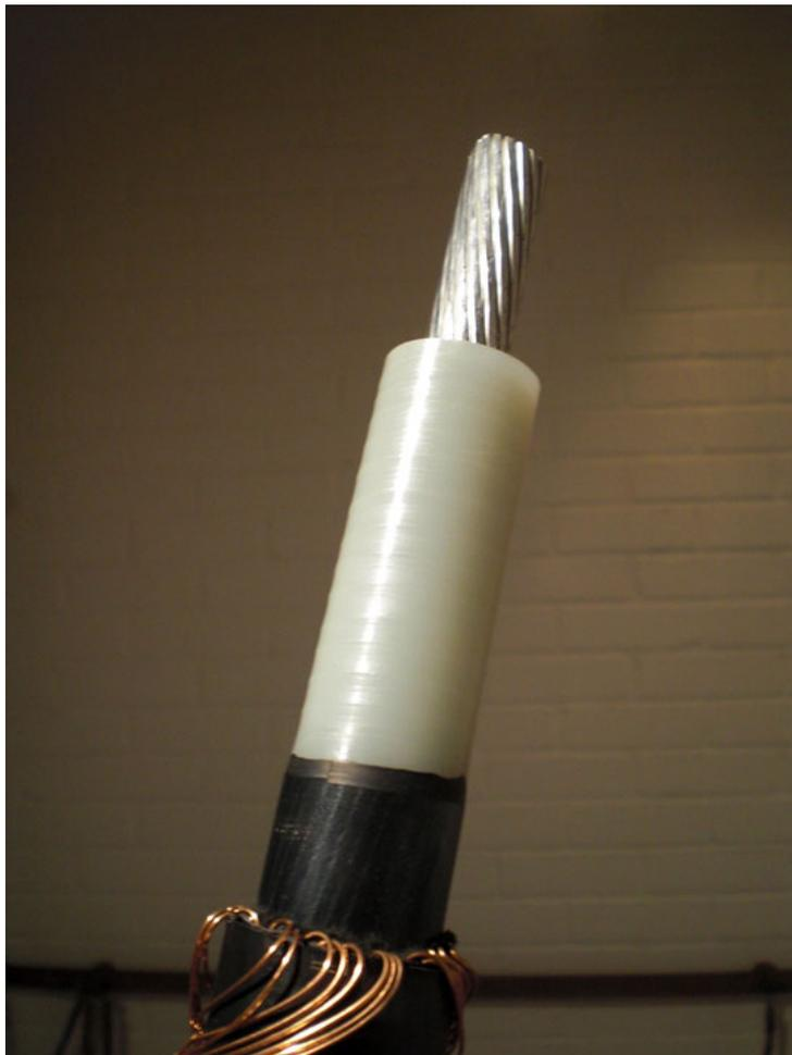
**Abbildung 10-14: Sechste Anordnung ( $C_p = 6$ ); Kabelprüfling, dessen Endverschluss einseitig entfernt wurde**
