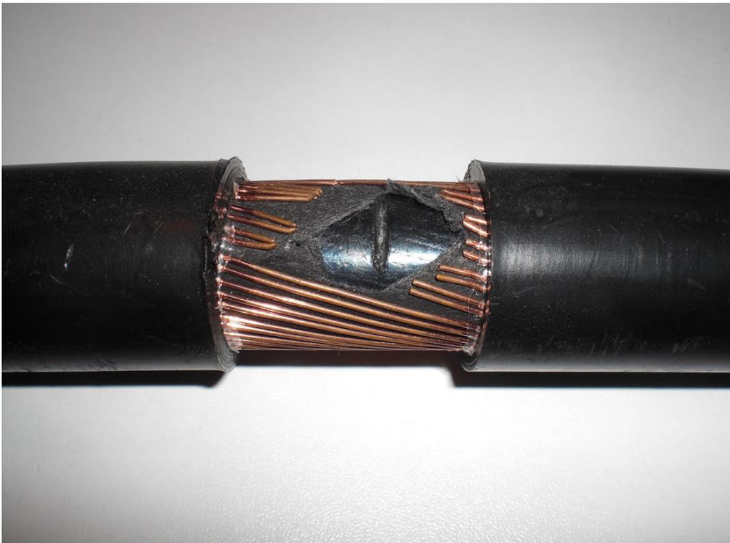
Abbildung 10-12: Vierte Anordnung ( $C_P = 4$ ); Kabelprüfling mit Schaden an der äußeren Leitschicht, am leitfähigen Band und am Schirm
