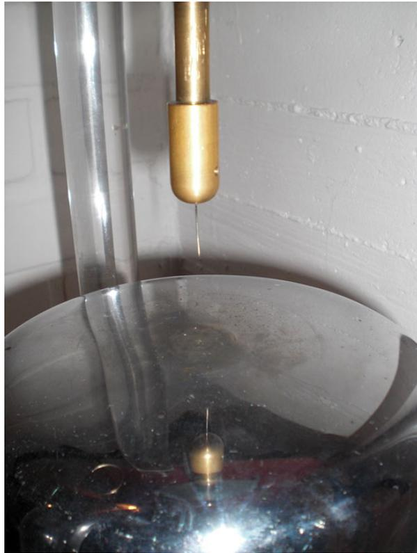
Abbildung 10-9: Erste Anordnung ( $C_P = 1$ ); Spitze-Platte-Anordnung
