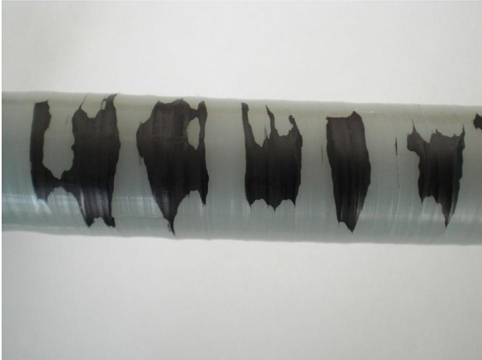
**Abbildung 10-13: Fünfte Anordnung ( $C_p = 5$ ); Kabelprüfling mit Resten der äußeren Leitschicht unter einem Endverschluss (fehlerhafte Montage des Endverschlusses)**
