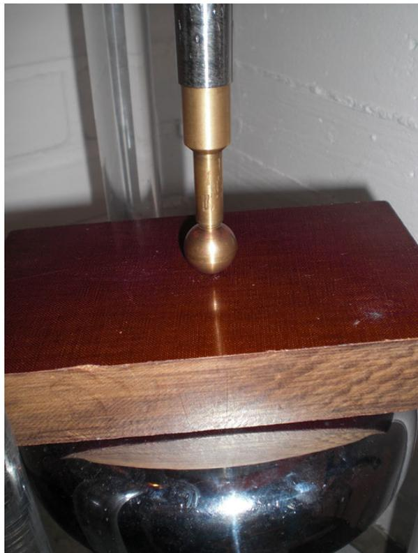
Abbildung 10-10: Zweite Anordnung ( $C_P = 2$ ); Oberflächen-Anordnung
