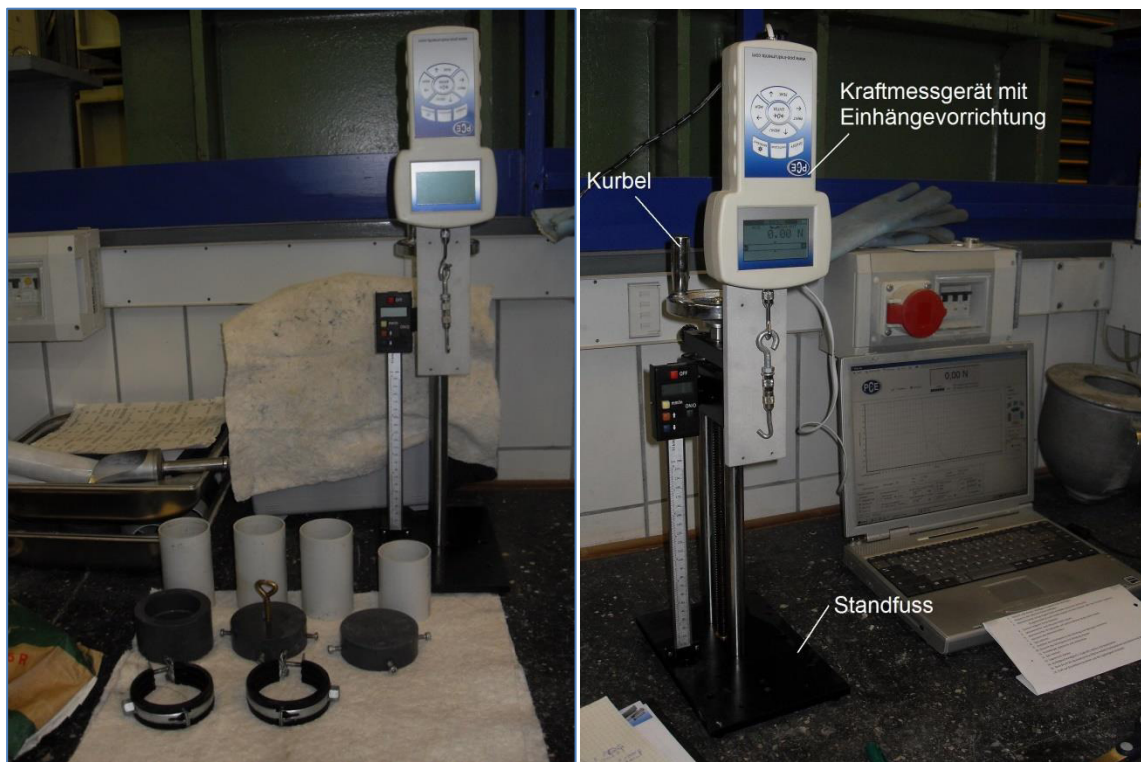
Abbildung 91: Variante 3 mit Versuchsstand und Einzelteilen [134]
