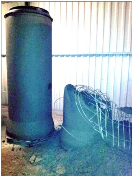
Abbildung 3: sofort entschalte Stahlbetonrohre aus erdfeuchtem Beton, rechtes Rohr nach der Herstellung kollabiert (Länge 2000 mm, Innendurchmesser 600 mm, Wanddicke 120 mm)
