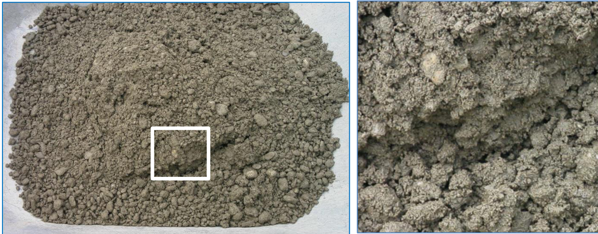
Abbildung 42: Erdfeuchter Beton für die Rohrproduktion mit 16 mm Größtkorn Kies, w/z-Wert 0,38; rechter Teil: vergrößerter Bereich des weißen Quadrates
