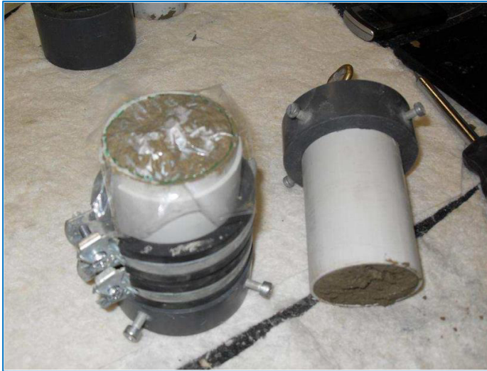
Abbildung 114: Ermittlung der tatsächlichen Bruchflächen beim zentrischen Zug an erdfeuchten Zementleimen durch Frischhaltefolie und anschließender manueller Flächenauszählung nach Bommes [134].
