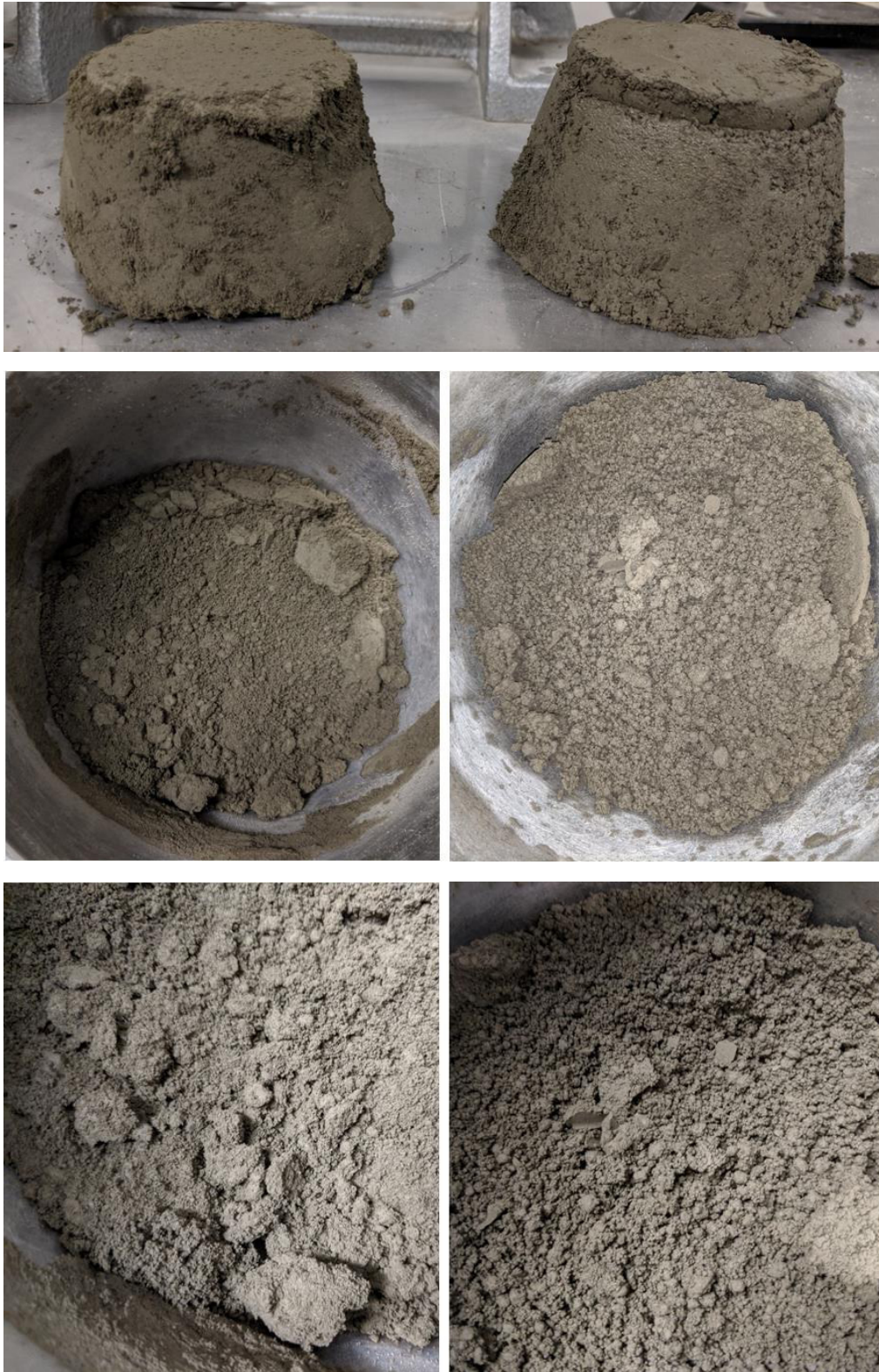
Abbildung 95: Zementleime mit CEM I 42,5 R, w/z = 0,21 und gleicher Mischdauer, unmittelbar nach dem Mischen und nach 15 Schlägen mit dem Hägermann-Tisch linke Seite: Mischreihenfolge Wasser langsam auf Zement, rechte Seite: Mischreihenfolge Zement langsam auf Wasser
