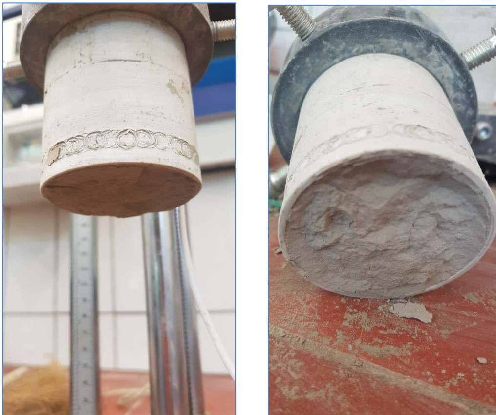
Abbildung 107: trockener Zement nach dem Zugversuch, links hängend ohne Entleerung, rechts: oberes Teilstück mit erkennbarem Bruchbild
