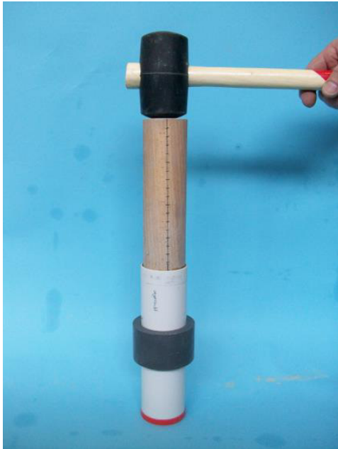
Abbildung 97: Versuchsaufbau Variante 1 (vergl. Abbildung 85) mit Stößel beim Einbringen der Verdichtungsenergie durch den Gummihammer [132]
