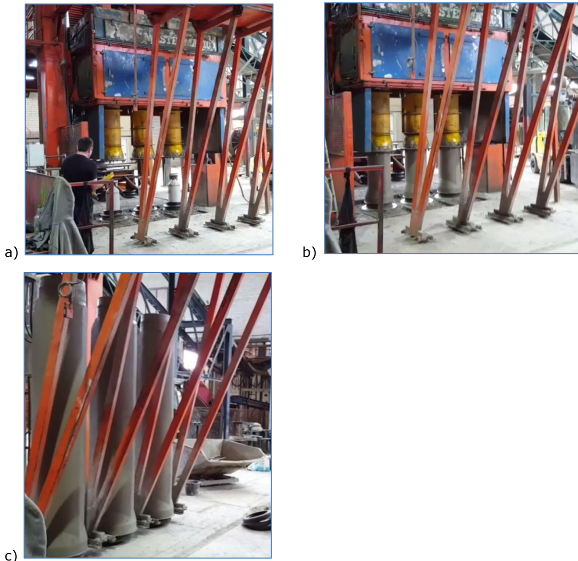
Abbildung 1: Herstellung von sofort entschalteten Rohren B-KF-GM 300 x 2500 a) Beginn des Zyklus: Innenkerne abgesenkt, Formenmantel fährt hinunter b) Befüll- und Verdichtungsvorgang beendet, Formenmantel fährt herauf c) fertige, frische Rohre werden von der Betonierstation verfahren
