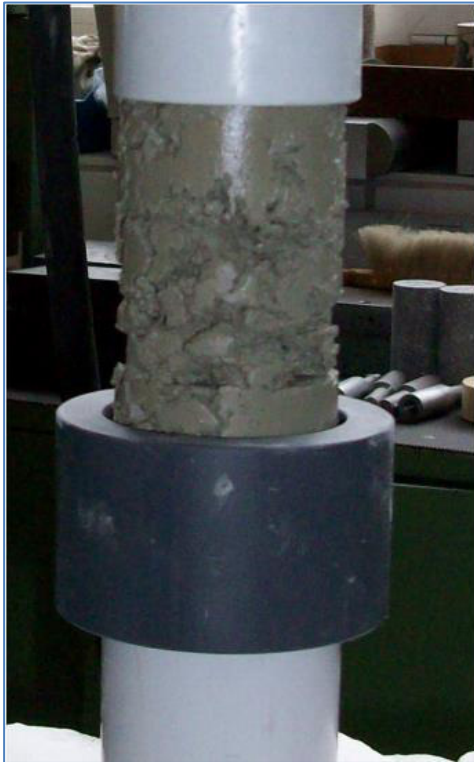
Abbildung 96: schlechter Verdichtungsgrad bei Verwendung der Humm-Sonde [132]
