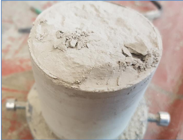
Abbildung 108: trockener Zement nach dem Zugversuch, unteres Teilstück: erkennbarer Zusammenhalt der einzelnen Partikel in größeren Agglomeraten
