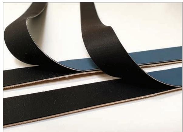
Abbildung 4.19: Gespaltene Drucktuchproben
