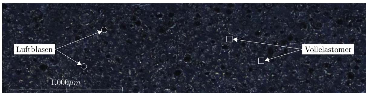
*Abbildung 8.14: Mikroaufnahme einer auf Mikrosphären basierenden Luftpolsterschicht*
