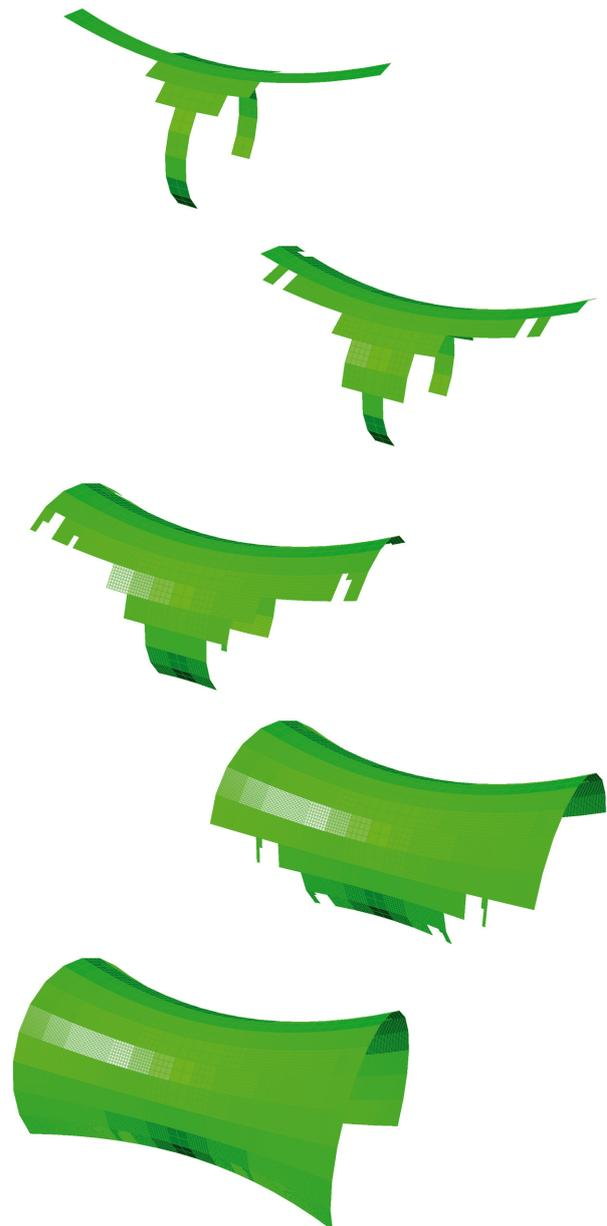
Abb. 53) Regelmäßige Zerlegung einer Fläche nach einer fraktalen Logik – jede Einzelfläche, die nach der Aufteilung außerhalb der Krümmungstoleranz liegt, wird im nächsten Schritt in vier weitere Flächen unterteilt.
