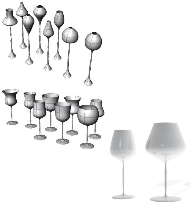
Abb. 10) Klick and evolve – verschiedene Zwischenschritte und zwei Ergebnisse von Außenformen von Weingläsern, erzeugt mit Hilfe eines interaktiven evolutionären Algorithmus. (Schein, 2006)
