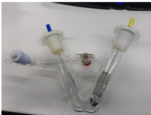
Abbildung 26 Erste Variante einer elektrochemischen Zelle in V-Form zum Arbeiten unter inerten Bedingungen.
