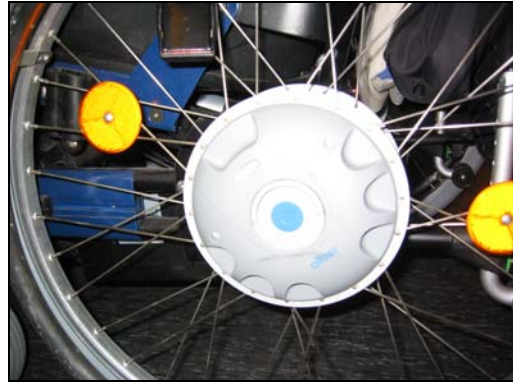
Abb. 8.31: Antriebsrad kann ausgekuppelt werden, dann im Handbetrieb E-Rollstuhl
