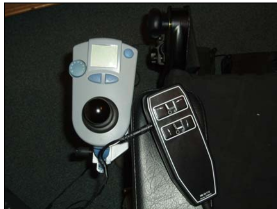
Abb. 8.29: Die Handsteueranlage des Elektro-Rollstuhls
