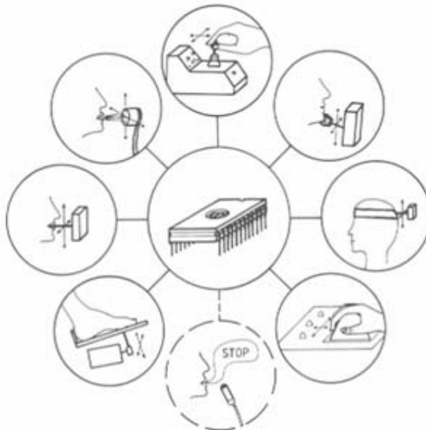
Abb. 6.29: Auswahl von Bedienvarianten für Elektro-Rollstühle
