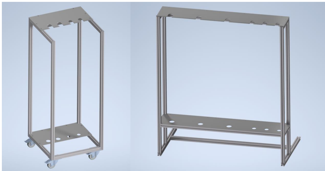
Abbildung 4.21.: Montagegestell für die Messstäbe (links) und Lagerungsgestell (rechts).
