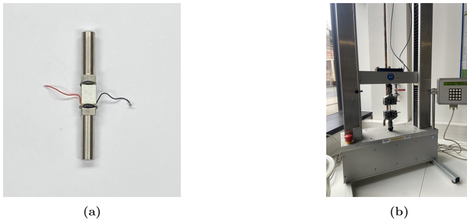
Abbildung 4.32.: a) Zwischen die Titanstücke geklebter Piezoaktuator, der im Zugversuch vermessen wurde. b) Versuchsaufbau des Zugversuchs.
