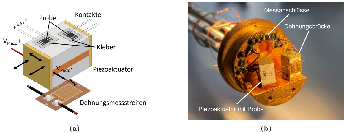
Abbildung 3.15.: a) Skizze des fertig kontaktierten Piezoaktuators mit den wesentlichen Elementen. b) Unteres Ende des Messstabs mit eingebautem Piezoaktuator mit Probe und Dehnungsbrücke.
