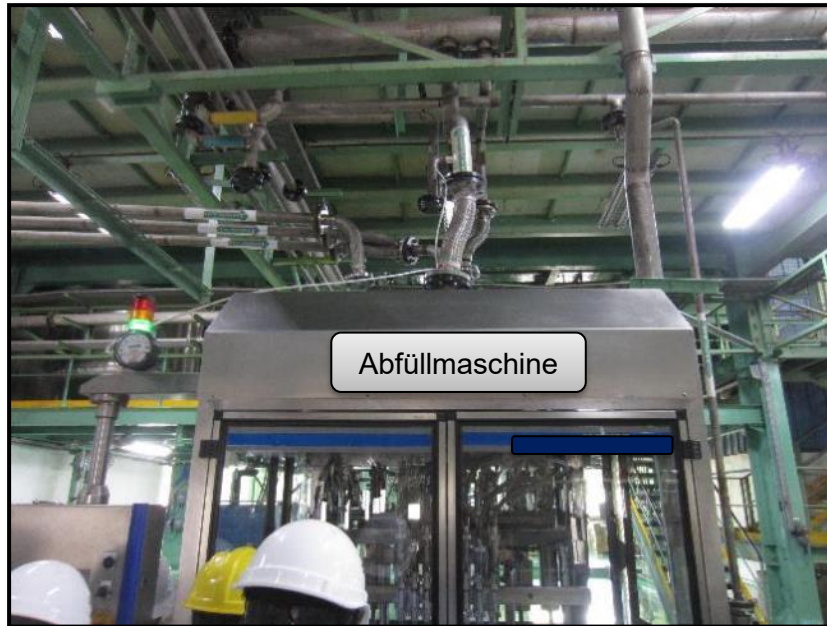
Abbildung 41: Darstellung einer Abfüllmaschine mit Warnleuchten im oberen Bereich der Maschine: Warnleuchtenfunktion: Warnung bei nicht ausreichender Lüftung (eigene Aufnahme)
