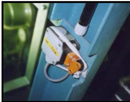
Abbildung 45: Manipulierter Rollenschwenkschalter (Pallowski, 2015, S. 7), Manipulierung durch ein einfaches Mittel (Kabelbinder)
