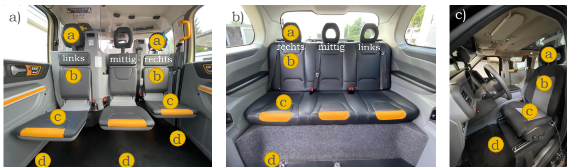
Abbildung D.1: Messpunkte a) auf den Klappsitzen, b) auf der Rückbank und c) auf dem Fahrersitz zu den Ergebnissen in Tabelle D.2.
