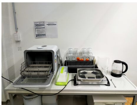
Abb. 48: Versuchsaufbau zur Durchführung des alkalischen Standard-Reinigungsprozesses.
