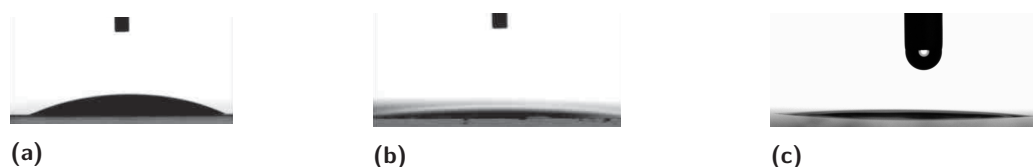
Abb. 44: (a) Statische Kontaktwinkelmessung auf nicht gereinigter Glasobjektträgeroberfläche mit \theta_{H_2O} von 25,5^\circ \pm 0,5 . (b) Statische Kontaktwinkelmessung auf Piranhasäure-gereinigter (Mischungsverhältnis 1 : 3 ( H_2O_2 : H_2SO_4 )) Glasobjektträgeroberfläche mit \theta_{H_2O} von < 10,0^\circ und (c) statische Kontaktwinkelmessung mittels Laborspülmaschinenreiner gereinigter Floatglasoberfläche mit \theta_{H_2O} von < 10,0^\circ ([157, S. 127]).
