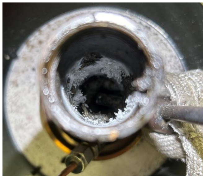
Abbildung 24: Kristalline Ablagerungen aus einer PET-Pyrolyse.
