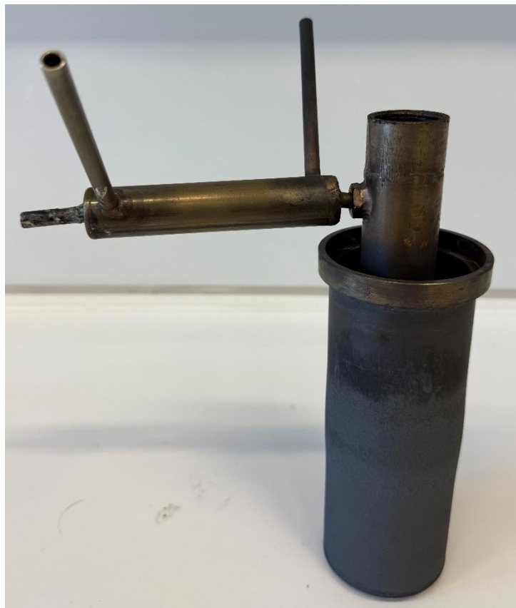
Abbildung 21: Pyrolyse Reaktor mit Nebenabgang und Kühlung.
