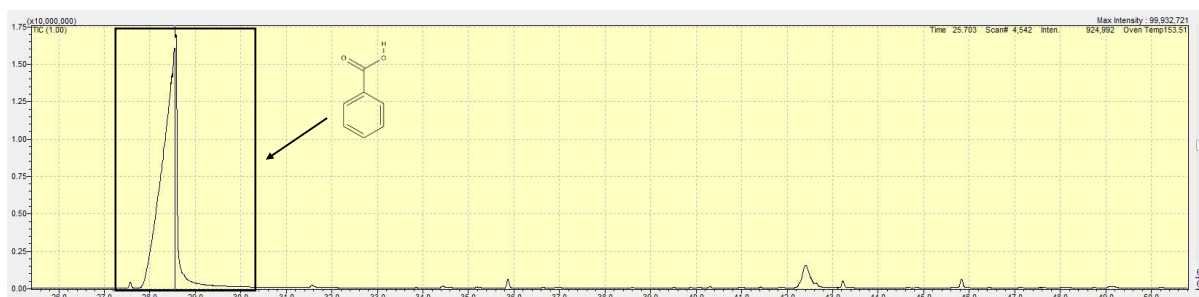
Abbildung 42: Chromatogramm des Pyrolyseproduktes des PET-Gewebes bei 450 °C.
