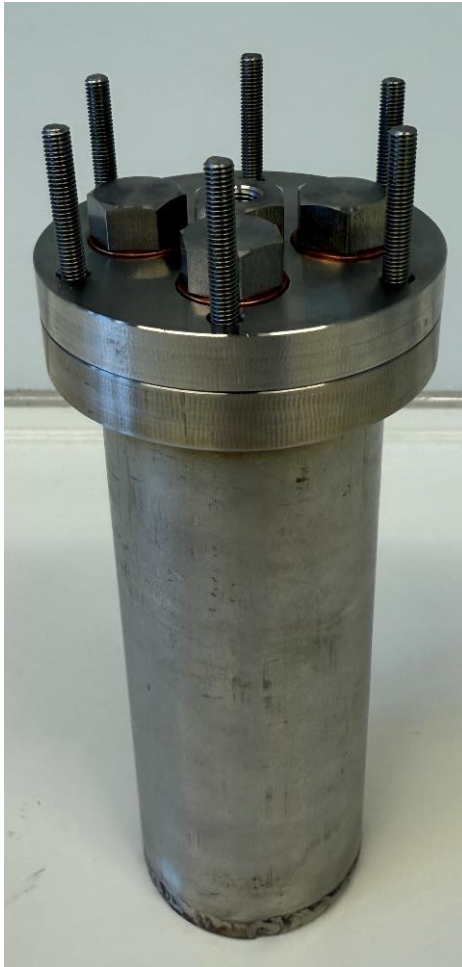
Abbildung 29: Endgültiges Design des Pyrolysereaktors mit diversen Anschlussmöglichkeiten.
