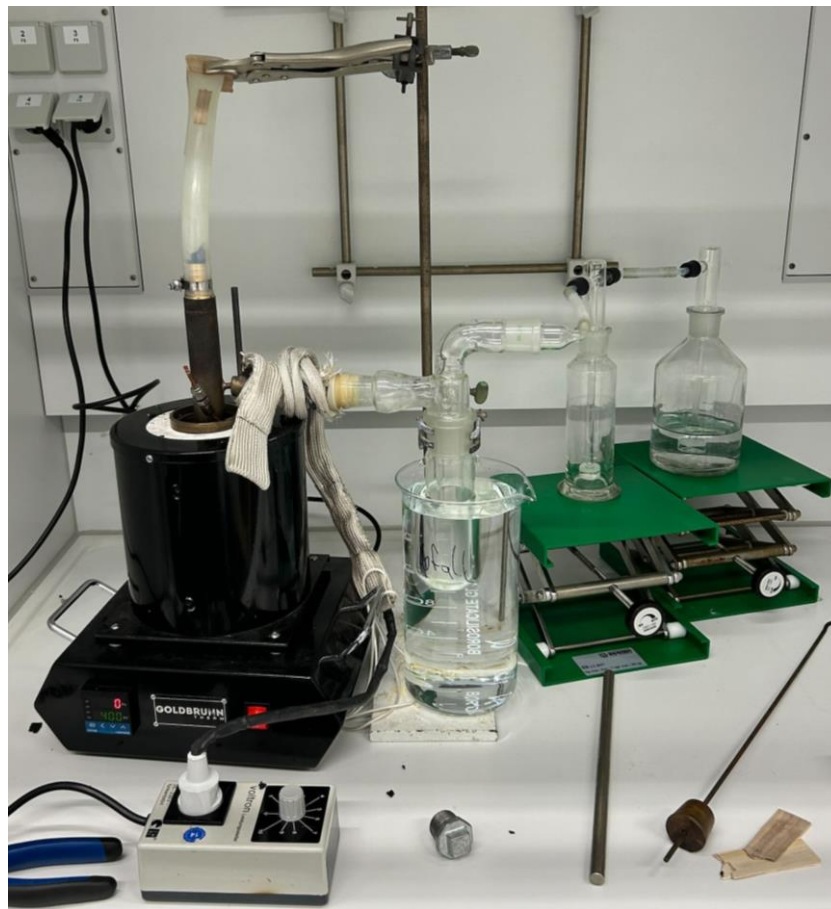
Abbildung 22: Erster Versuchsaufbau des Pyrolysereaktors.
