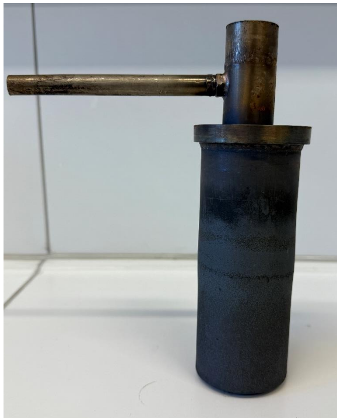
Abbildung 23: Pyrolyse-Reaktor mit überarbeitetem Nebenabgang.
