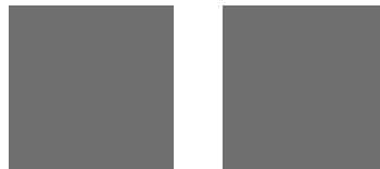
Abbildung 1.1: Röntgenprojektion von zwei Objekten unter monochromatischer Strahlung bei 6 MeV. Gleiche Größe, gleiche Graustufe, gleiches Objekt? Links: 10 cm Durchstrahlung durch Aluminium. Rechts: 8.8 mm Durchstrahlung durch Wolfram. Die genannten Materialien wurden aufgrund ihrer stark unterschiedlichen Abschwächung der Röntgenstrahlung gewählt.
