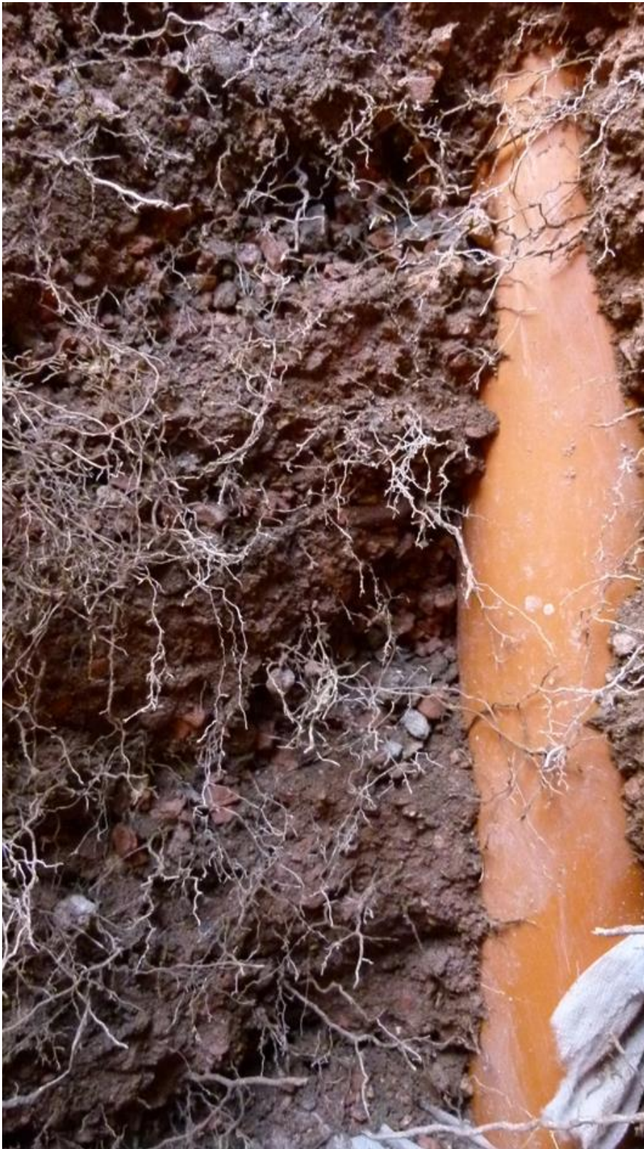
Bild 257: Dresden, Erprobung Dohnaer. Str. – Nachweis der Durchwurzelung einer Tiefenbelüftungsbohrung im Jahr 2011
