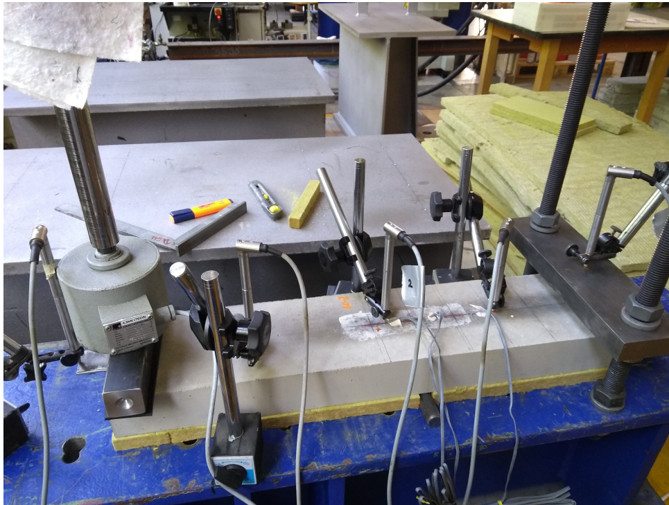
Abbildung D.2.: Aufbau Balkenversuch (Probe 60-2)
