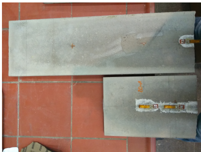
(a) Draufsicht Probe 20-1 mit angeklebten DMS (Riss durch DMS 1)
