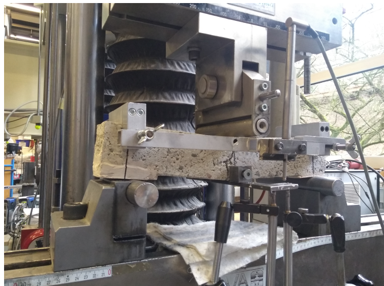
Abbildung C.1.: Aufbau eines verformungsgesteuerten Biegezugversuchs
