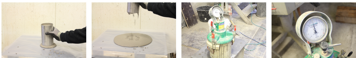
Abbildung D.1.: Bestimmung Ausbreitmaß und LP-Gehalt
