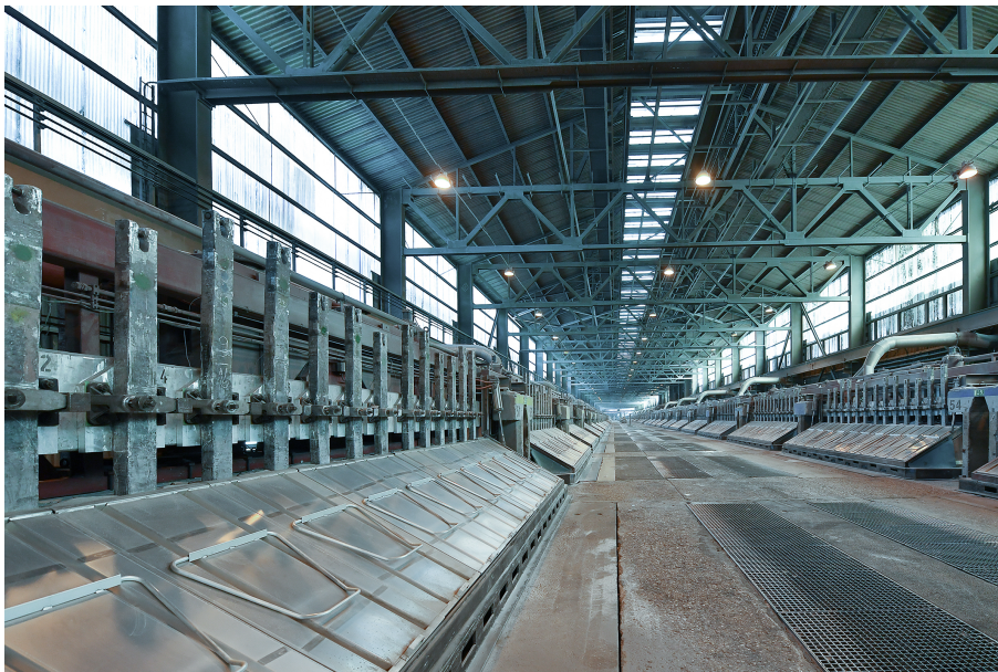
Abbildung 1.2: Ende-zu-Ende-Anordnung der PBPF-Öfen, die von der TRIMET in einer der drei Hallen in Essen betrieben werden. Das Bild wurde von der TRIMET zur Verfügung gestellt.
