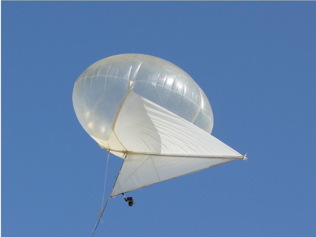
Abbildung 3.2: Helikite -Ballon mit Kamera 81
