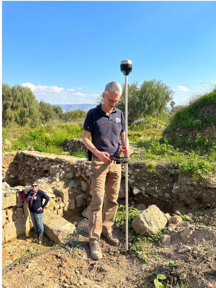
Abbildung 4.5: RTK-GNSS Emlid Reach RS2 im Einsatz in Tiberias 119
