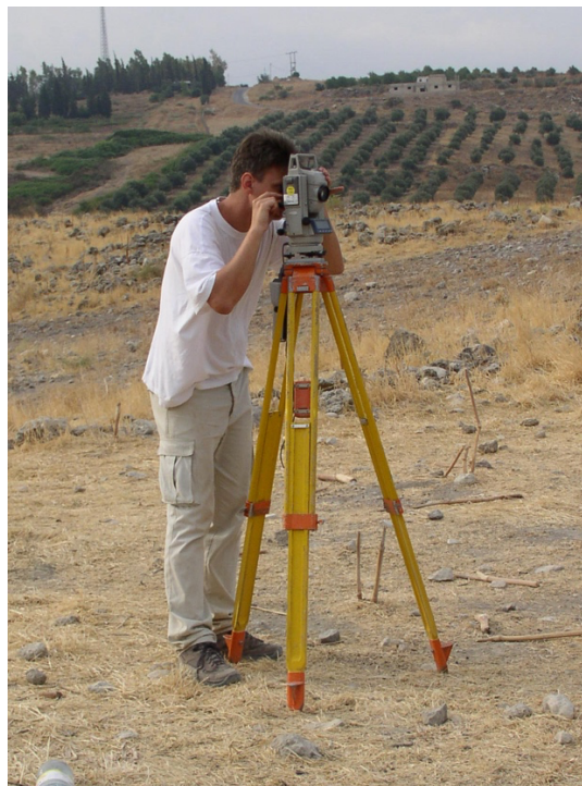
Abbildung 4.3: Tachymeter im Einsatz auf dem Tall Zirā'a 108
