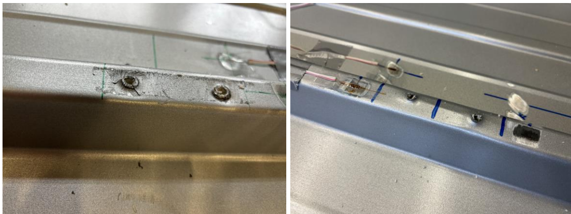
Abb. 3.3.4 Schadenbild am Obergurt nach zykl. (l.) und stat. Lasteinleitung (r.)
