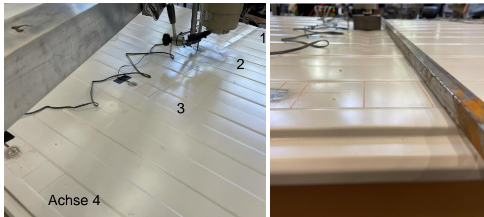
Abb. 3.2.21 Versagen Druck 0,50-2 PIR-L-140
