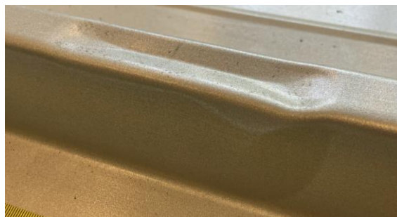
Abb. 3.2.43 Ausgebeulter Steg der inneren Rippe (4,0 kN)
