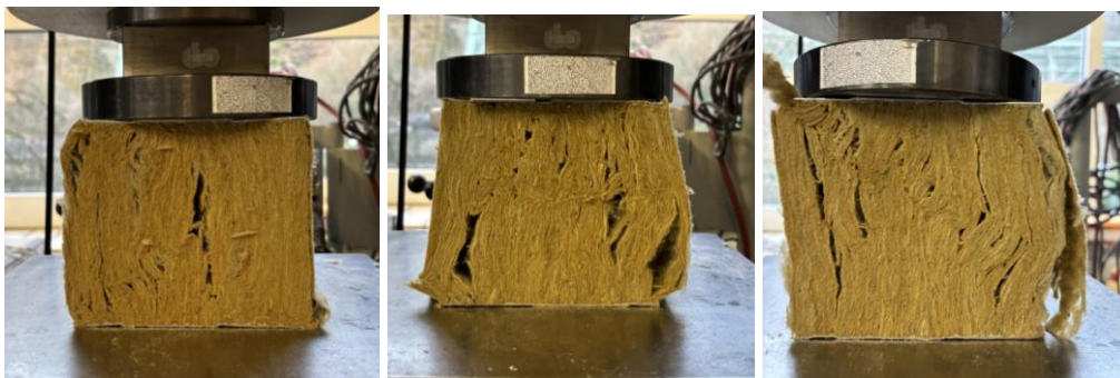
Abb. 3.4.4 Bruchbilder der MW-Würfel
