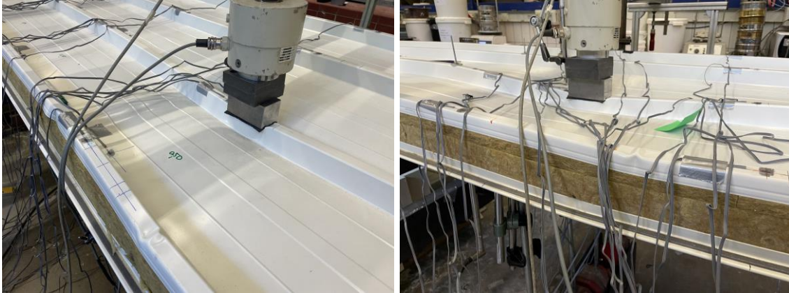
Abb. 3.2.48 Versagensbild Druck MW-T-60; l. 0,50-2, r. 0,15-2
