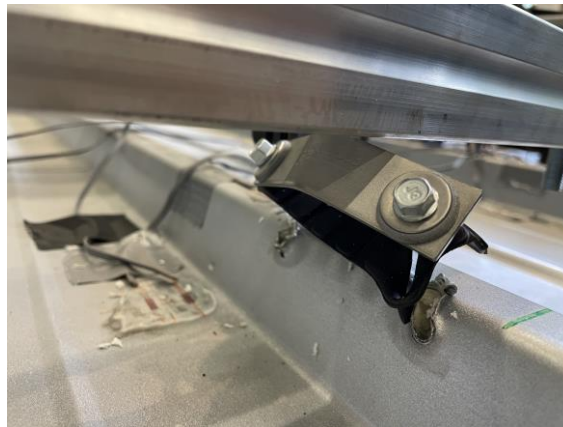
Abb. 3.2.55 Versagensbild Zug bei einseitiger Befestigung (PIR-T-60)
