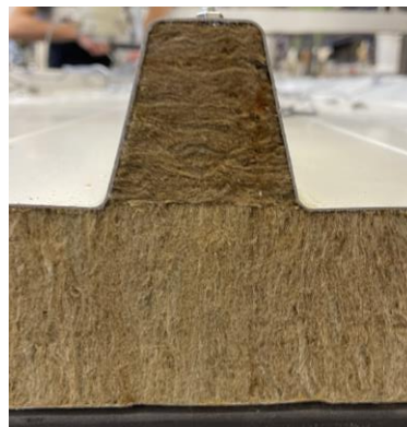
Abb. 4.3.7 Faserorientierung der profilierten MW-Elemente
