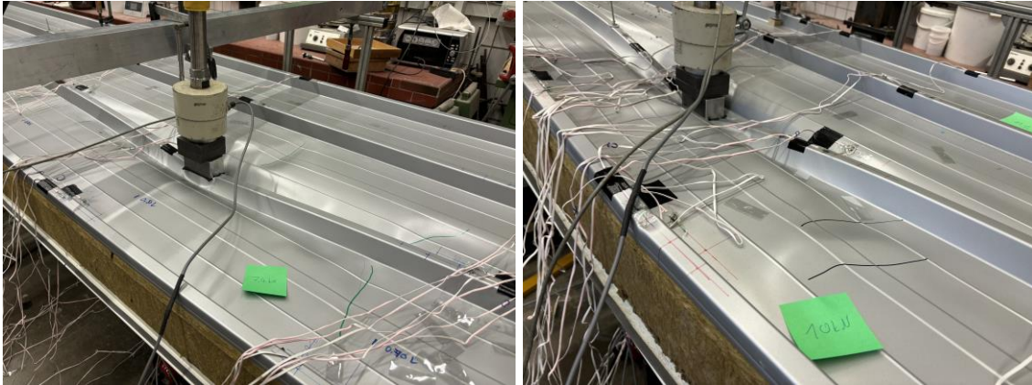
Abb. 3.2.52 Versagensbild Druck MW-T-140; links 0,50-2, rechts 0,15-2
