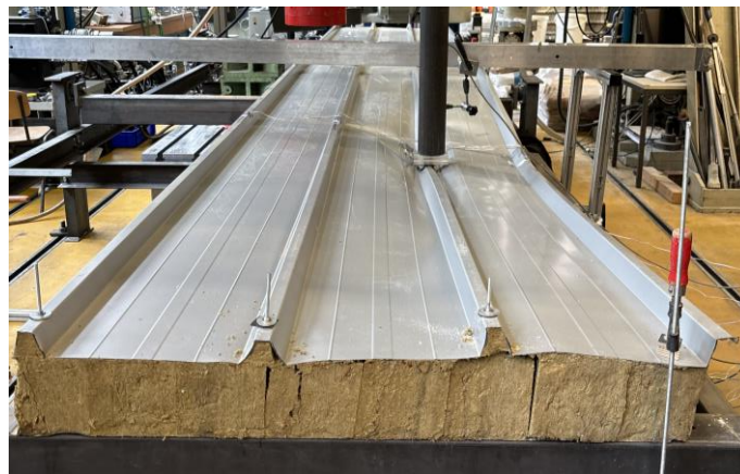
Abb. 3.2.36 Beispiel für sichtbare Klaffungen im Traglastversuch
