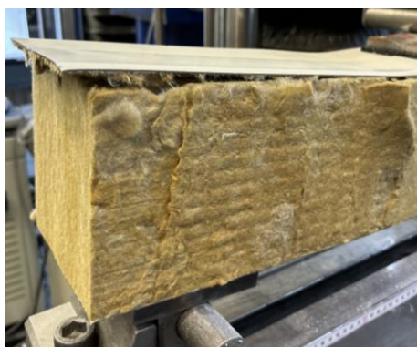
Abb. 3.4.3 Schubversagen in der Klebefuge am Auflager (Delaminierung)
