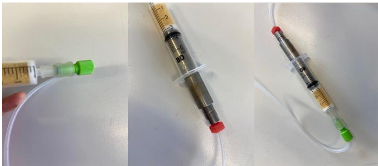
Abbildung 3.4: Vorbereitung der Katalysatorkartusche.
