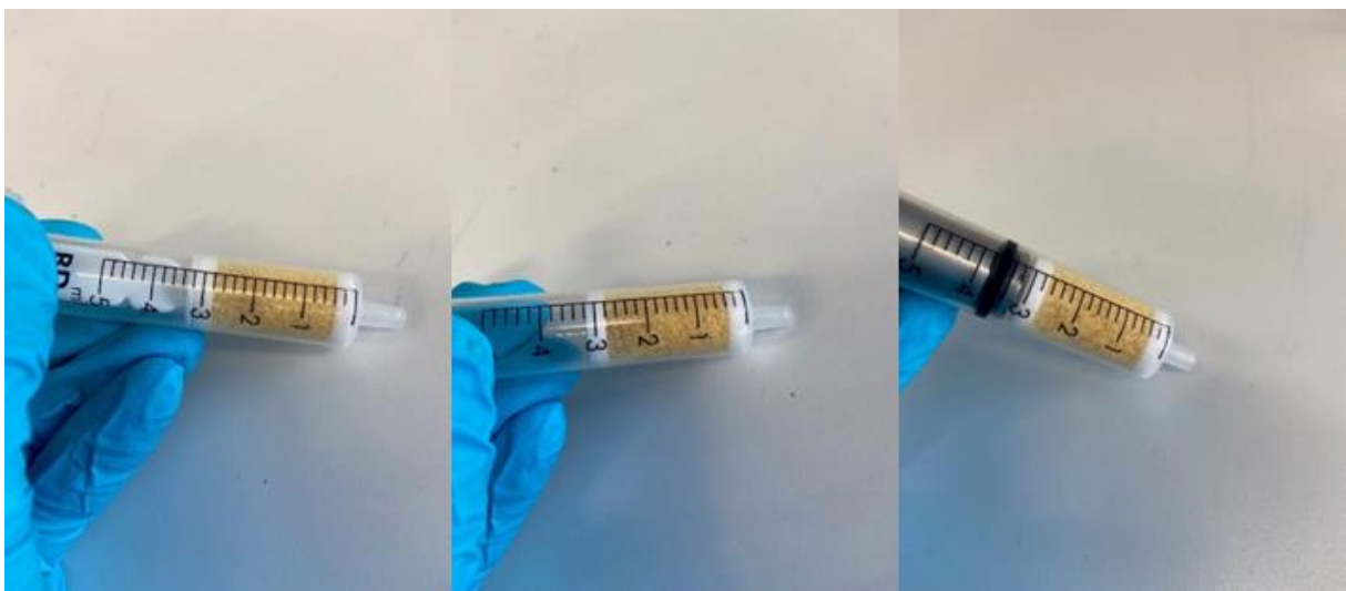
Abbildung 3.3: Vorbereitung der Katalysatorkartusche.
