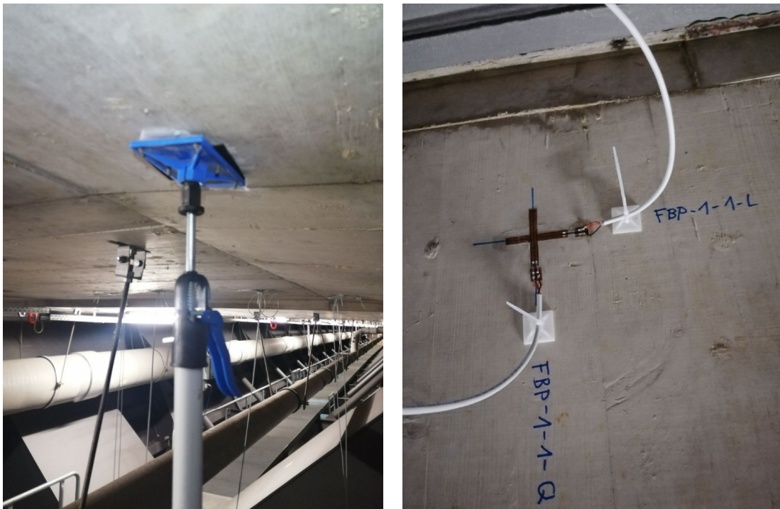
Abb. C.2: Aufbringung konstanter Druck während Klebphase und fertiggestellter biaxialer DMS
