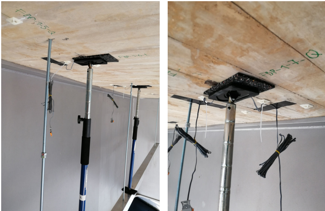
Abb. D.2: Aufbringung konstanter Druck während Klebphase über Hilfstraversen und Montagegestreben
