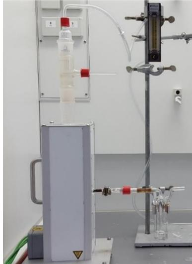
Abbildung 5.7: VCI-Verbrennungsapparatur mit Waschflasche und Rotameter
