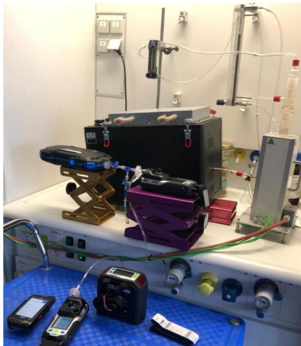
Abbildung 5.6: VCI-Verbrennungsapparatur im eigenen Versuchsaufbau mit temperiertem Gasprobenaufbewahrungsraum und angeschlossenen Vor-Ort-Analysesystemen
