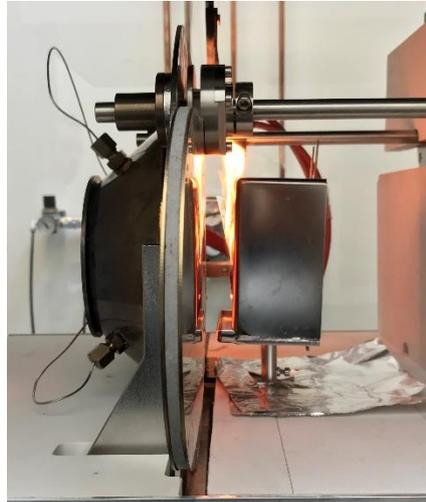
Abbildung 5.3: Cone-Kalorimeter im vertikalen Aufbau
