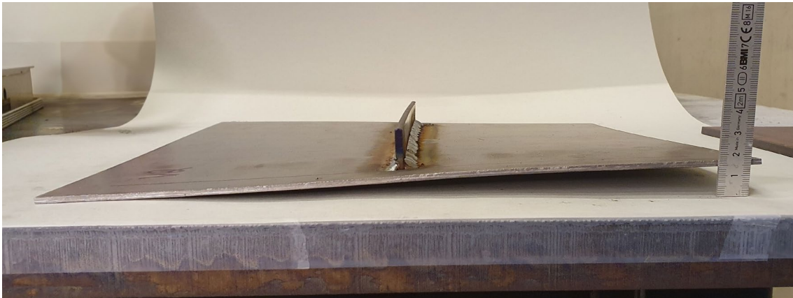
Bild 3.26 Einfaches Beispiel für geometrische Imperfektion infolge Schweißens
