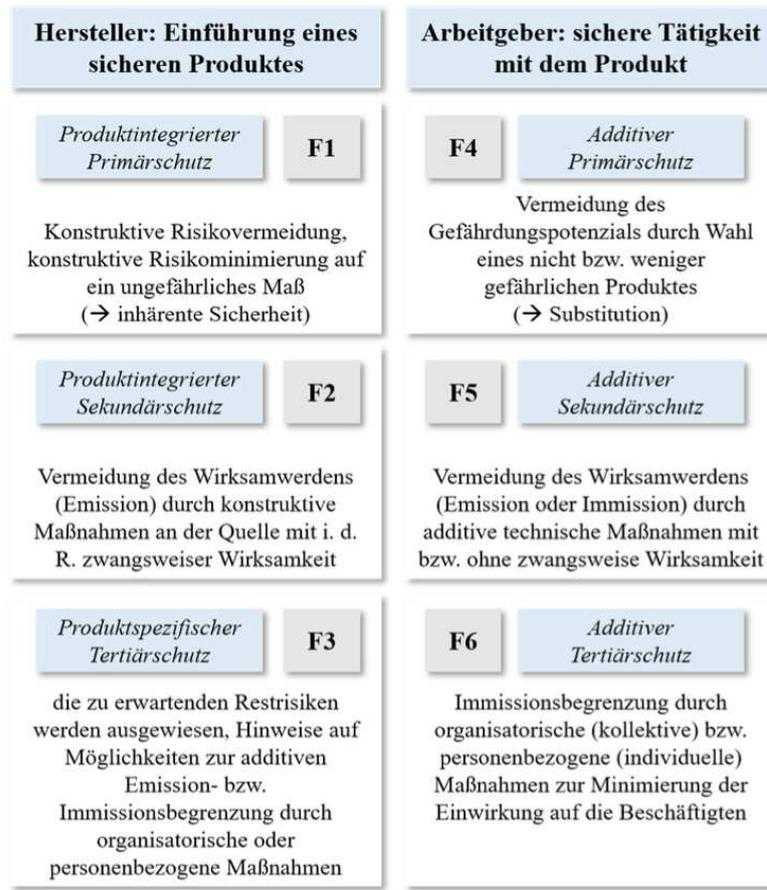
Abbildung 3-11: Gestaltungsrangfolge Schutzmaßnahmen inkl. STOP-Prinzip (eigene Abbildung nach Kahl (2017))
