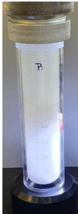
**Abbildung 18: Aufnahme des Emulsions-Stabilisierungstests mit PEG-60 hydriertem Rizinusöl in DME nach 25 Minuten.**
