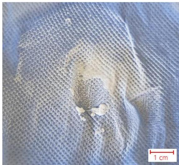
**Abbildung 17: Aufnahme des Sprühbildes mit PG-2 Diisostearat in Propan auf einem texturierten Substrat (Laborpapier).** Die Emulsion blieb während des Sprühprozesses so stabil, dass sich durch Versprühen der Formulierung eine feine Eisschicht auf dem Laborpapier bildete.
