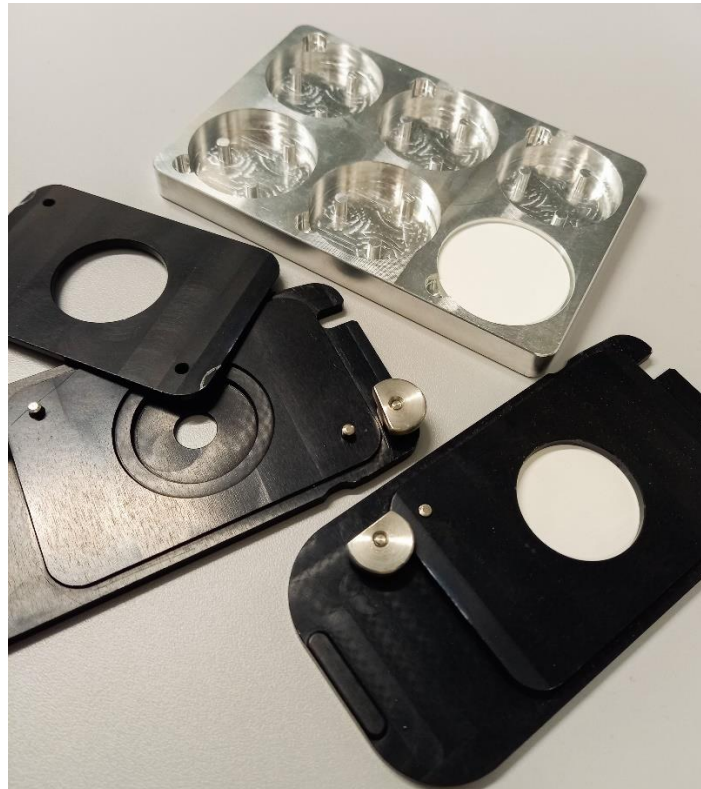
Abbildung 13: Filterhalterungen für den Nanoliter-Dispenser (oben, gefrästes Aluminium) und für den Mikrodosierer (unten, beschichteter Edelstahl).
