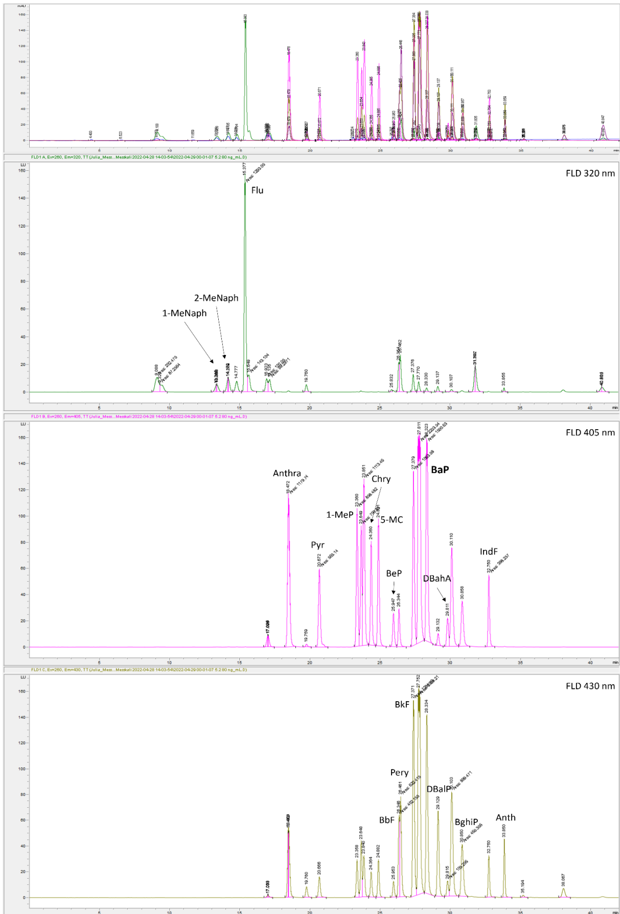
Abbildung 15: Beispielchromatogramm einer HPLC-Messung mit dem Gesamtchromatogramm (oben) und den wichtigsten FLD-Signalen (320, 405 und 430 nm) mit einigen markierten PAK.
