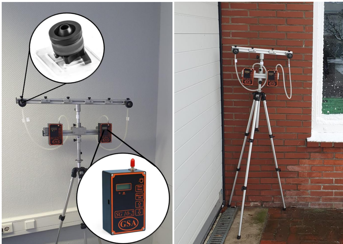
Abbildung 5: Beispielhafte PAK-Probenahme mit SG-10-Pumpen und GSP10-Probenahmeköpfen. © Daniel Köster (IFA) und GSA Messgerätebau GmbH
