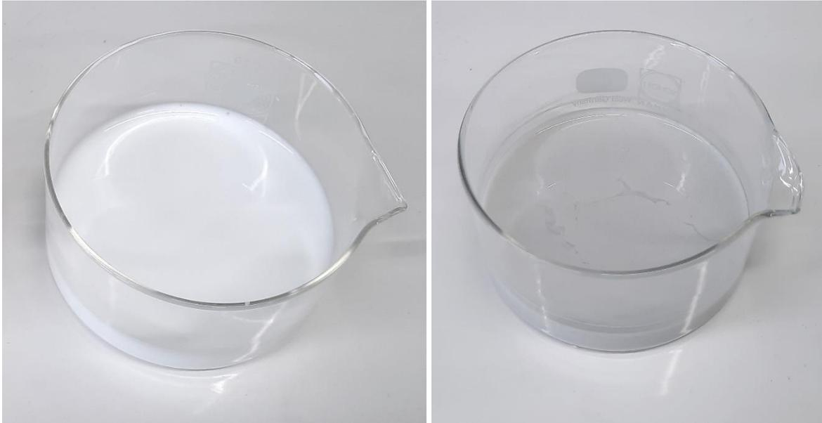
Abb. 20: Titandioxidsuspension vor der Bestrahlung (links) und nach der Zugabe von Reagenzien und einer Bestrahlungszeit von 10 Minuten (rechts)
