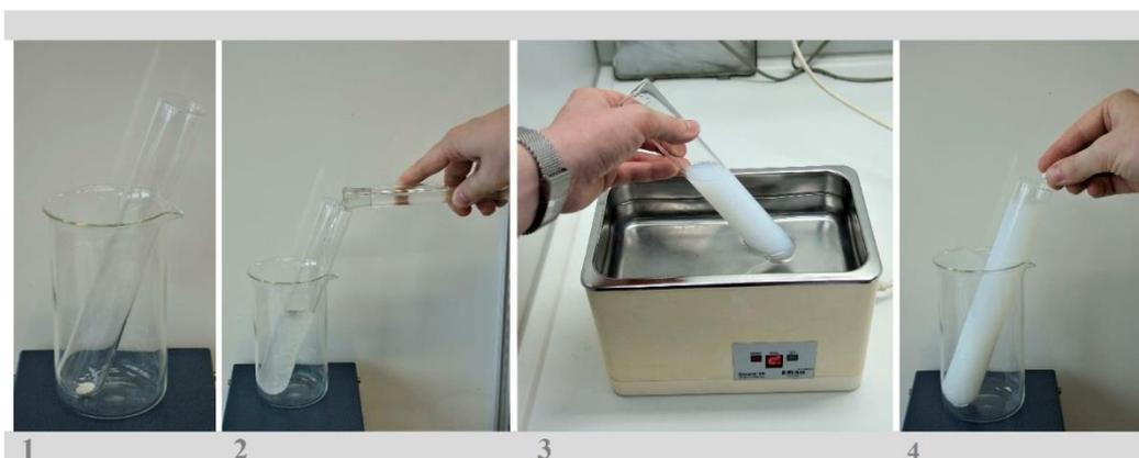
1 Wiegen Sie 50 mg des TiO<sub>2</sub>/Pt-Katalysators in einem großen Reagenzglas ab.
