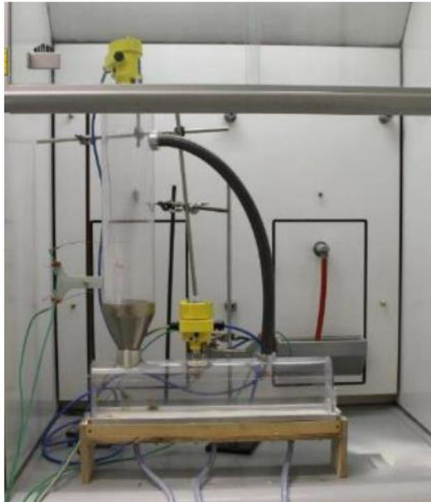
**Bild 55:** Versuchsmodell einer nicht-entkoppelten Trocknungskammer zur Auswirkungsbetrachtung, vgl. (Kulosa 2017)
