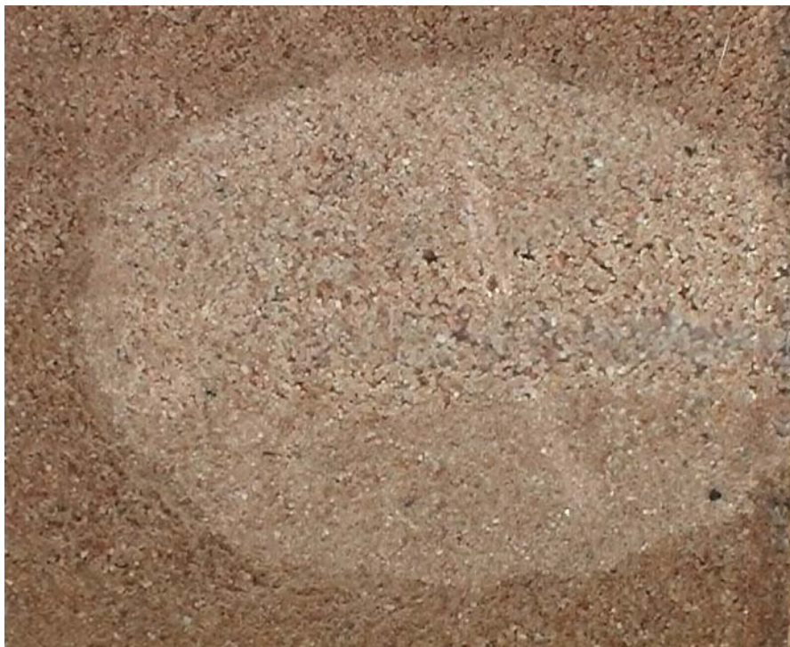
Abbildung 3.12: gestörter, durchmischter, aufgelockerter Bodenbereich nach Beendigung des Versuchs
