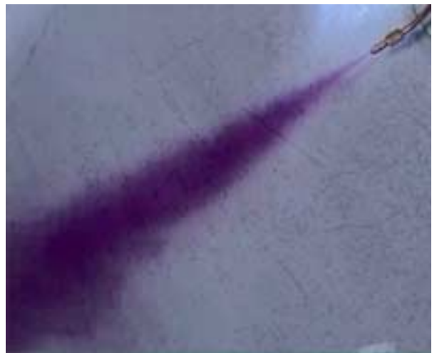
Abbildung 4.12: Ausbreitung eines Wasserstrahls in Wasser
