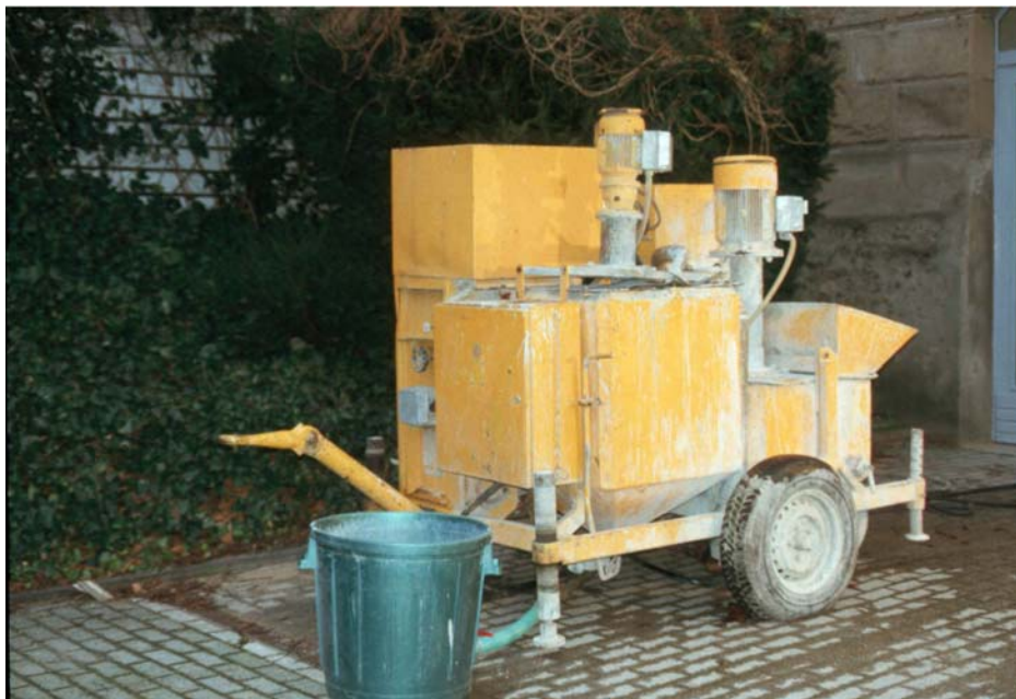
Abbildung 3.2: elektrisch betriebene Zweikolbenpumpe
