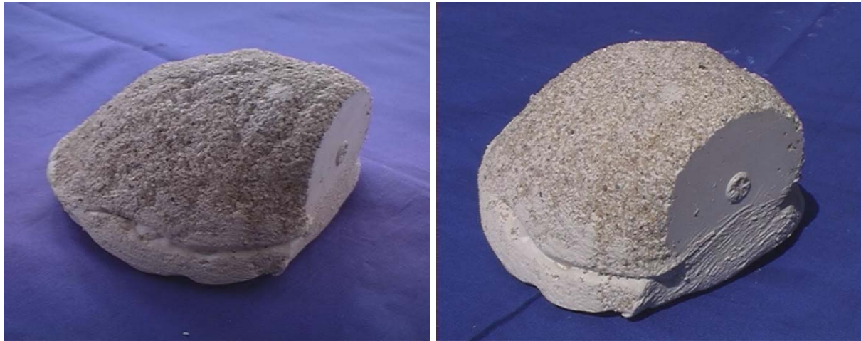
Abbildung 5.13: Zwei unterschiedliche Perspektiven der sich infolge einer horizontalen Einwirkung ausbildenden Bruchmuschel
