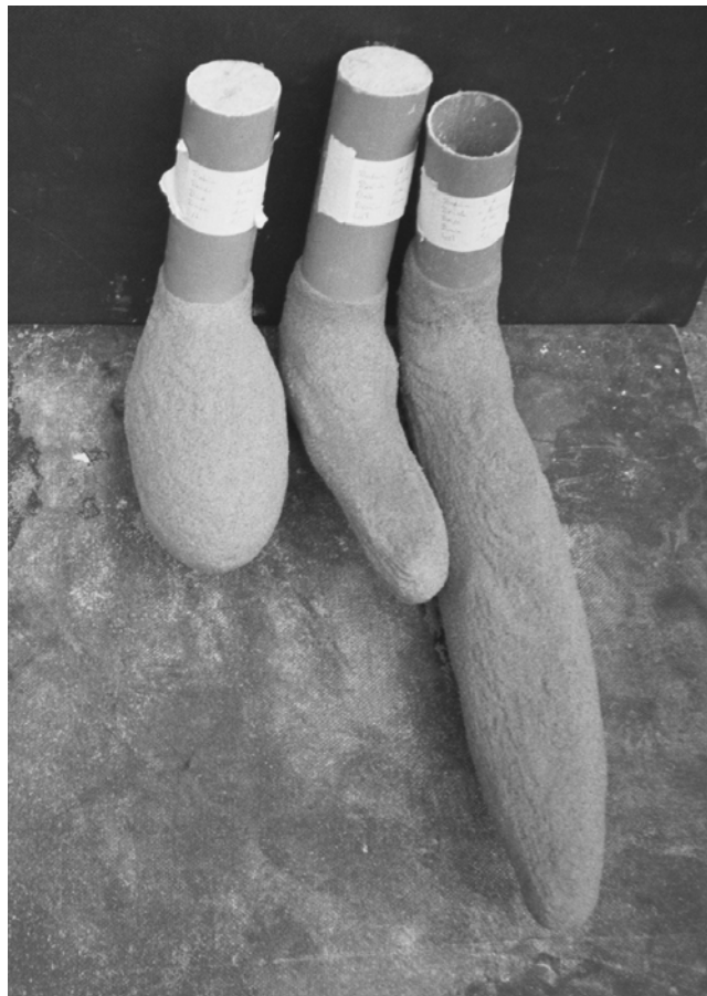
Abbildung 3.1: unter einem Druck von 85 bar ( \varnothing Düse 1,51 mm) hergestellte Verpresskörper bei identischen Versuchsrandbedingungen
