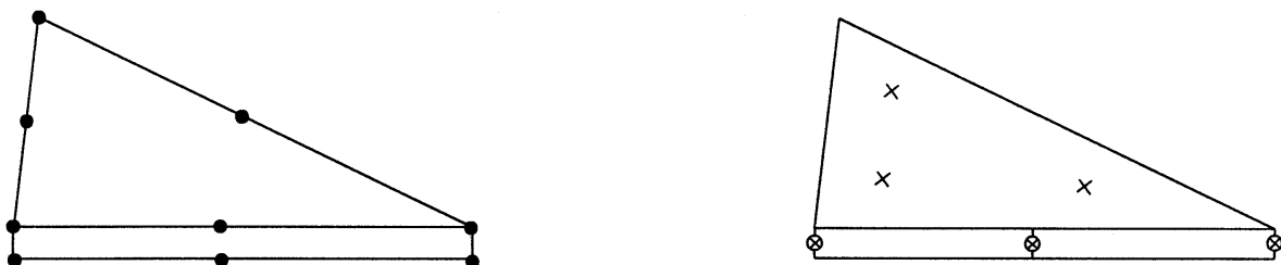
Abbildung 8-8: Knoten- und Spannungspunkte von Boden- und Kontakt-Elementen
