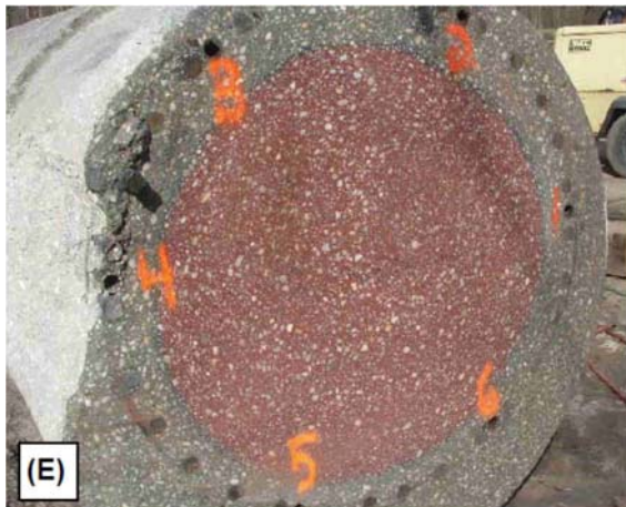
Bild 7 Foto des Querschnitts des Bohrpfahls, der mit einem üblichen Kontraktorbeton (a.) und mit einem selbstverdichtenden Beton (b.) hergestellt wurde [17]
