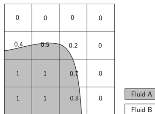
Bild 16 Schematische Darstellung eines zweidimensionalen Gitters mit zwei Fluiden und den berechneten (hier: flächenbasierten) \alpha -Werten
