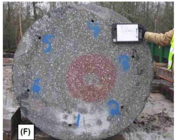
Bild 7 Foto des Querschnitts des Bohrpfahls, der mit einem üblichen Kontraktorbeton (a.) und mit einem selbstverdichtenden Beton (b.) hergestellt wurde [17]
