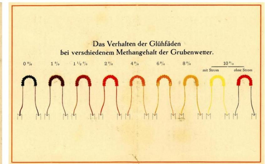
Bild 4: *Wetterlicht III*, Glühintensitäten (Prospekt der GFNI, Kiel: Schlagwetteranzeiger Wetterlicht III, um 1926, S. 4)
