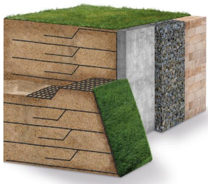
Abb. 2.1: Ausführungsvarianten der Frontgestaltung von geogitterbewehrten Stützwänden
