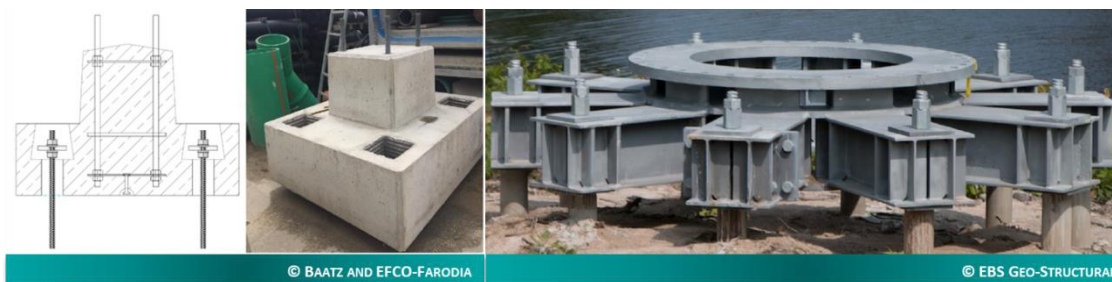
Abb. 4.3: Effizient bauen: Einsatz von Fertigteilenelementen (Fundamentkörpern)
