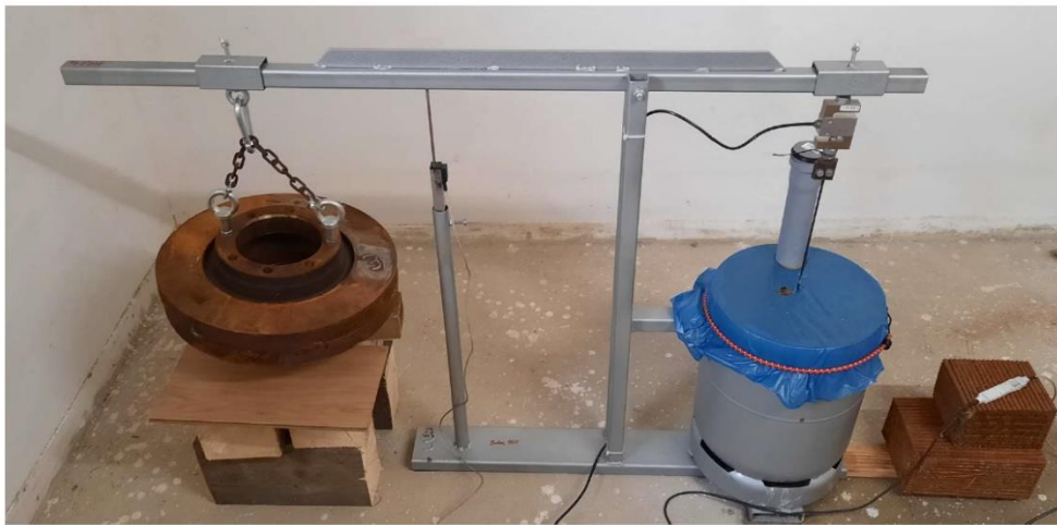
Abb. 3.2: Versuchsaufbau zur Beprobung von eingebauten PET-Geogittern unter konstanter Zugbeanspruchung in kalkstabilisierten Böden (Strahberger, 2023)
