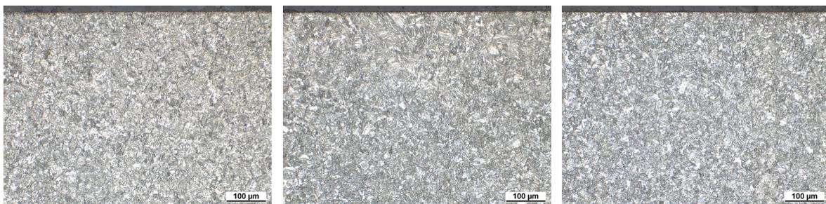
**Abbildung 61:** Exemplarische Abbildungen der mit Nital geätzten Materialproben aus Walzmaterial. Dargestellt sind v.l.n.r. die Proben in Walzrichtung, 45° zur Walzrichtung und quer zur Walzrichtung entnommenen und kontrastierten Proben.
