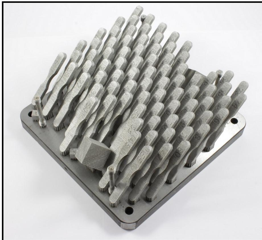
**Abbildung 32:** Isometrische Ansicht eines Bauzyklus mit WBP in 45°-Richtung.
