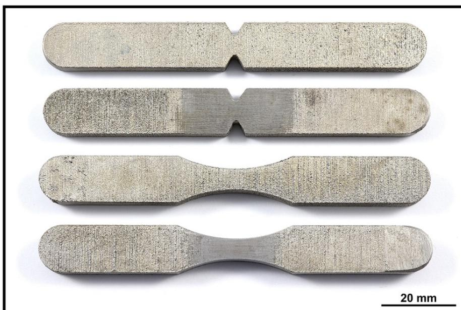
**Abbildung 23:** Darstellung der gekerbten und ungekerbten Wechselbiegeproben im wie-gebaut und geschliffenen Zustand nach dem Einsatzhärten und anlassen bei 180°C.
