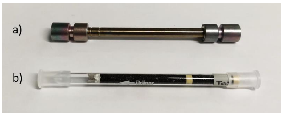
Abbildung 1: a) Edelstahl-Probenahmeröhrchen; b) Aktivkohle-Quarzglas-Probenahmeröhrchen
