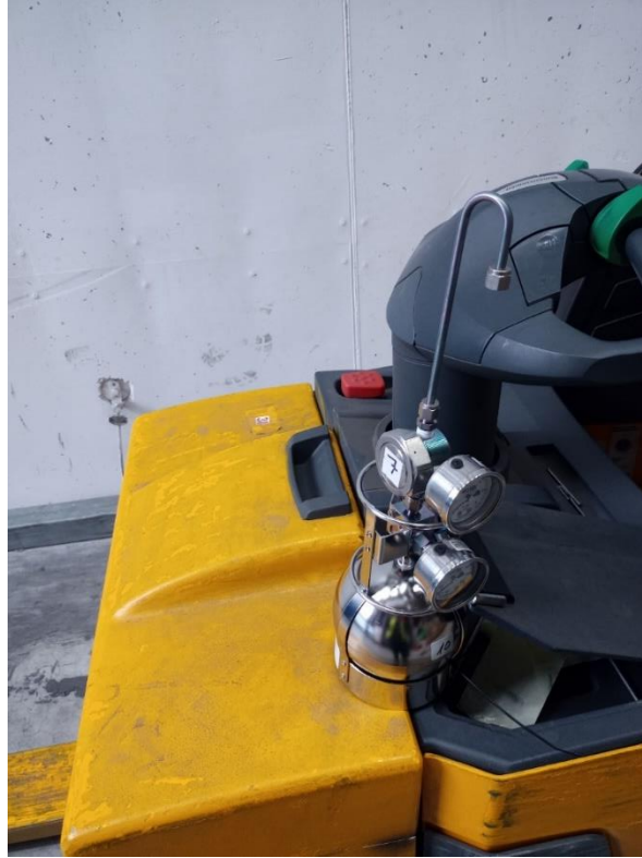
Abbildung 57: Probenahmekanister fixiert auf der Front einem Hubwagen (umgs. Ameise) zum Transport der Paletten nach erfolgter Sterilisation
