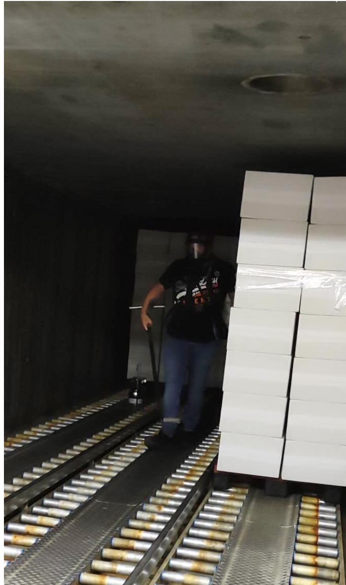
Abbildung 58: Mitarbeiter mit Frischluftmaske als PSA beim Ausräumprozess von sterilisierten Paletten aus einer Sterilisationskammer nach abgeschlossenem Sterilisationsprozess
