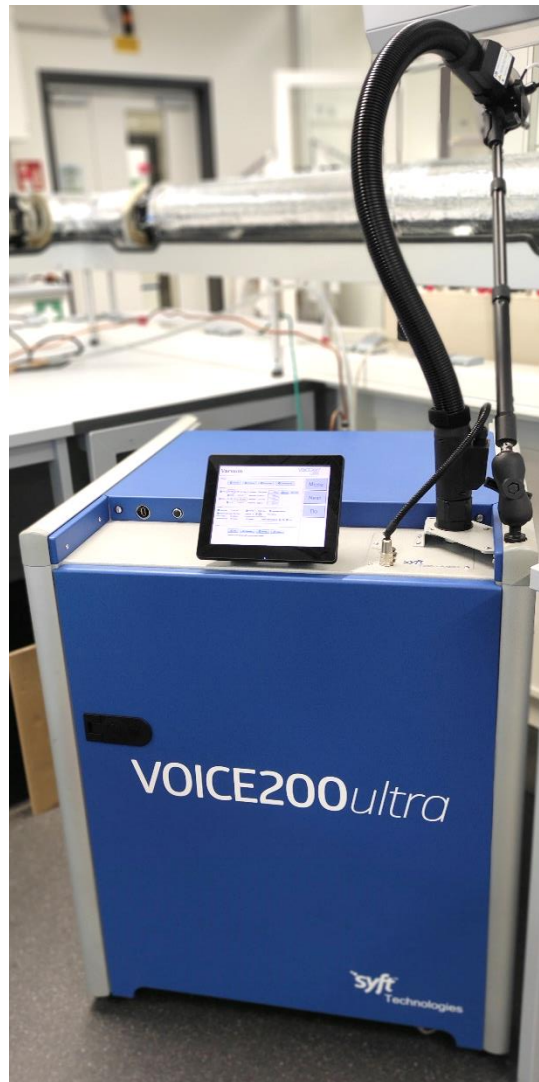
Abbildung 17: Voice 200 Ultra SIFT-MS Gerät (Syft, Christchurch, NZ) angeschlossen an die Prüfgasstrecke
