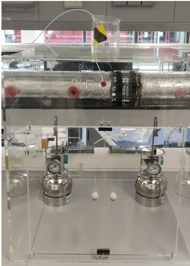
Abbildung 59: Messaufbau für die Simulationsmessungen zur Ethylenoxid-Exposition bei Entpacken von Sterilgut; Echtzeit-Monitoring über das SIFT-MS; Probenahme für anschließende Analyse über zwei 1 L-Probenahmekanister
