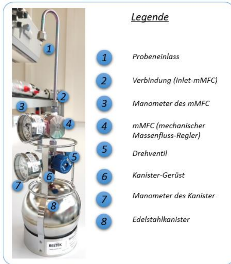
Abbildung 4: Kanister-Probenahmesystem; Kanister verbunden mit Probenahmeaufsatz
