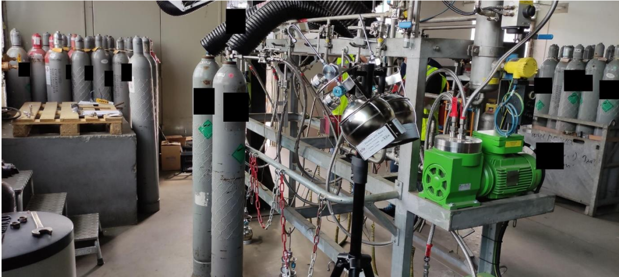
Abbildung 54: Flaschenreinigungsanlage mit Pumpe zur Evakuierung und platzierte Probenahmekanistern
