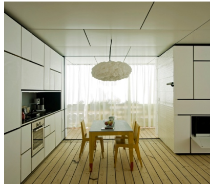
Foto 5.2.1-2: SD EU 2012 TRA: Hier sind in die Raumabtrennungen Schränke, Technikflächen und die Küche integriert. Zusätzlicher Raumverlust durch Konstruktionsflächen konnte bei gleichzeitig hohem akustischem Komfort minimiert werden. Quelle: (Solar Decathlon Europe)
