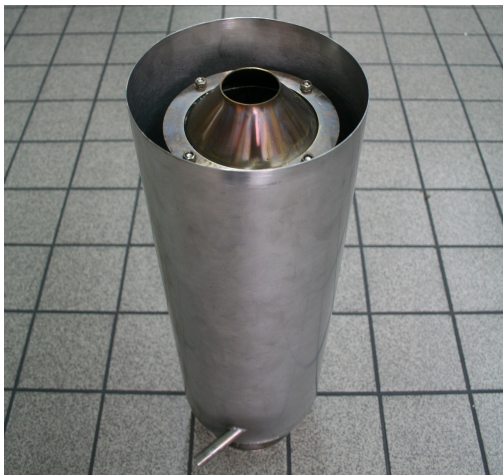
(a) Abgasrohr Nr. ④ (Abgasrohr ③ mit Hüllrohr): Hüllrohr, Schlauchanschlüsse und Blende
