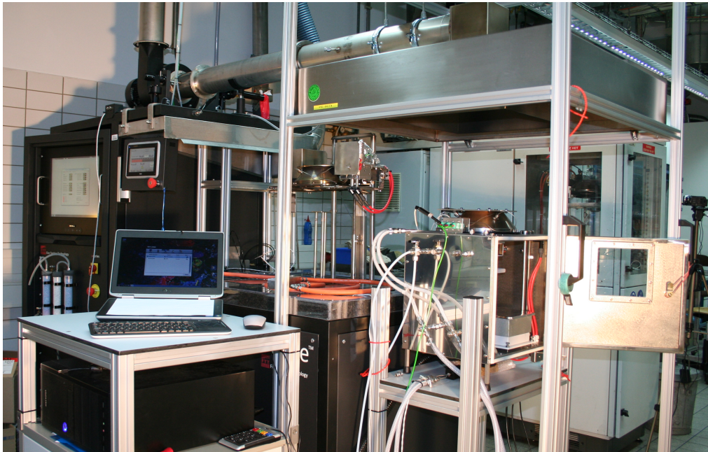
(a) Open Controlled-atmosphere Calorimeter: Überblick der freistehend unter der Abzugshube platzierten Atmosphärenkammer (ohne Abgasrohr)
