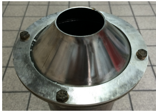
(f) Abgasrohr Nr. ③ (d. h. Abgasrohr ② mit Blende) und 3. Abdichtung: Strömungsblende
