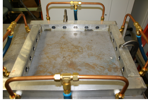
(b) Zuluft-Hohlprofile ohne Atmosphärenkammer: Schlauch- und Rohranschlüsse von Mischkammer kommend, Bohrungen an den Innenflächen
