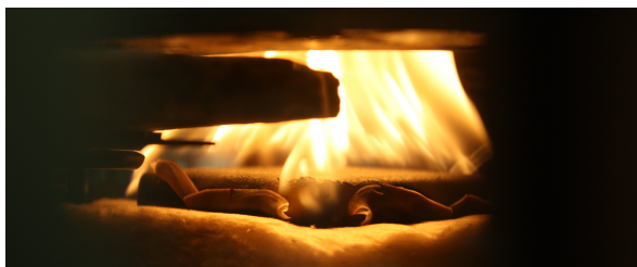
Abb. B.5: PMMA-Brand bei 20,95 Vol.%O 2 : Flammenbild (Referenz)
