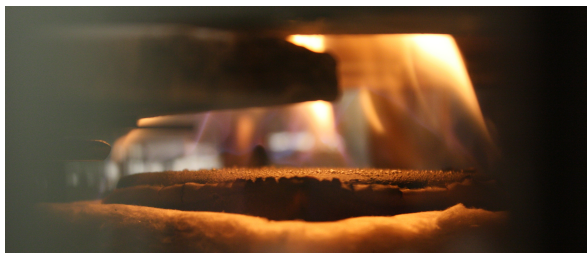
Abb. B.6: PMMA-Brand bei 15 Vol.%O 2 : Bläulich abgehobenes, transparentes Flammenbild Engl.: Lifted flames
