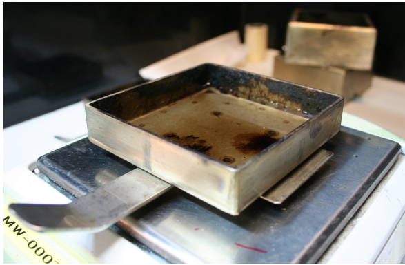
Abb. B.4: Entzündbare Flüssigkeit in Probenhalter: n-Heptan Charge: Heptan03 Perspektivansicht 50 g in 50 g Aqua dest.
