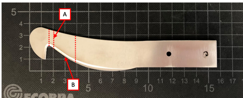
Abbildung 106: Die Hakenklinge wurde an den gekennzeichneten gestrichelten Linien getrennt. Die Probe A wurde als Querschliff eingebettet und analysiert. An der Probe B wurde die Schneide im REM analysiert.
