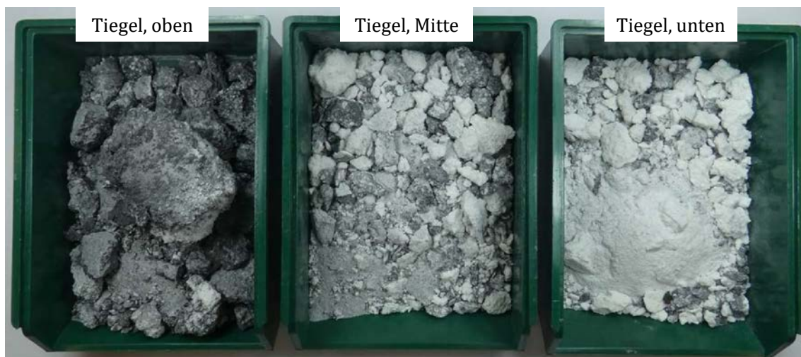
Abbildung 3.46: Aus dem Tiegel entnommener Elektrolyt nach einem Versuch mit 0,4 A/cm 2
