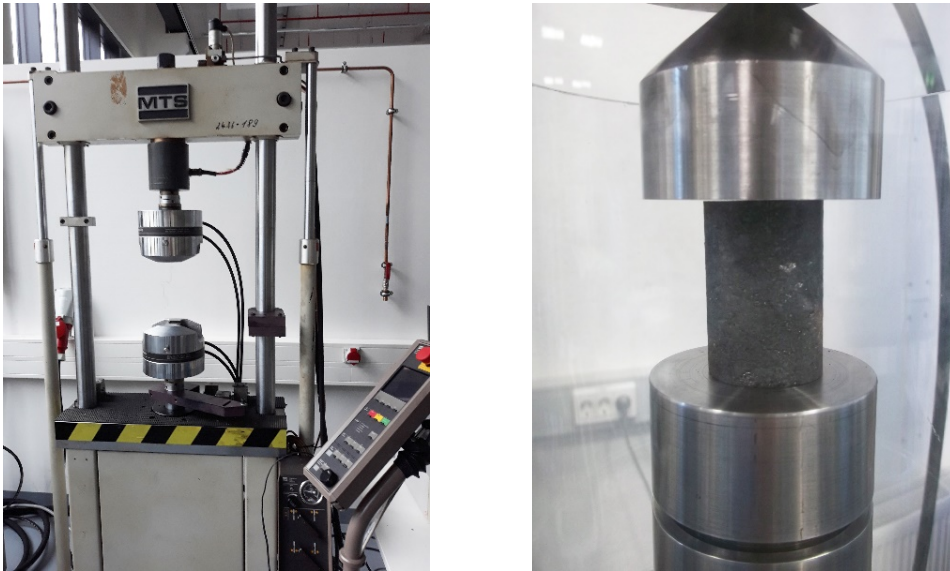
Abbildung 3.25: Prüfmaschine und Vorrichtung zur Durchführung des Druckversuchs
