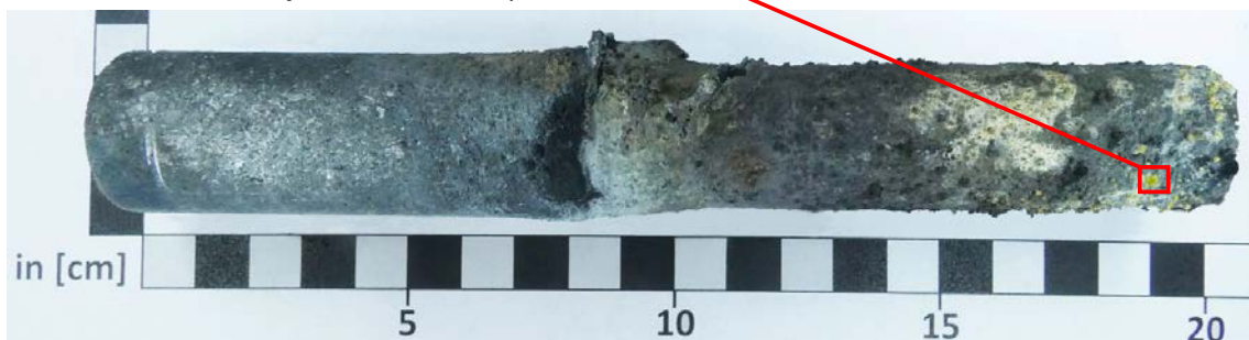
Abbildung 4.37: Proben aus dem Werkstoff G2 nach einer 24-stündigen Elektrolyse mit 0,8 \text{ A/cm}^2 mit 1 Zyklus bei 960-40 \text{ }^\circ\text{C} und 12 Zyklen bei 960\pm 40 \text{ }^\circ\text{C}
