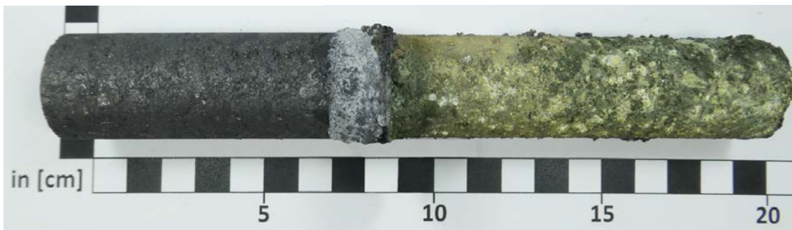
Abbildung 4.29: Probe aus dem Werkstoff G2 nach einer 24-stündigen Elektrolyse bei 940 °C und 0,8 A/cm 2
