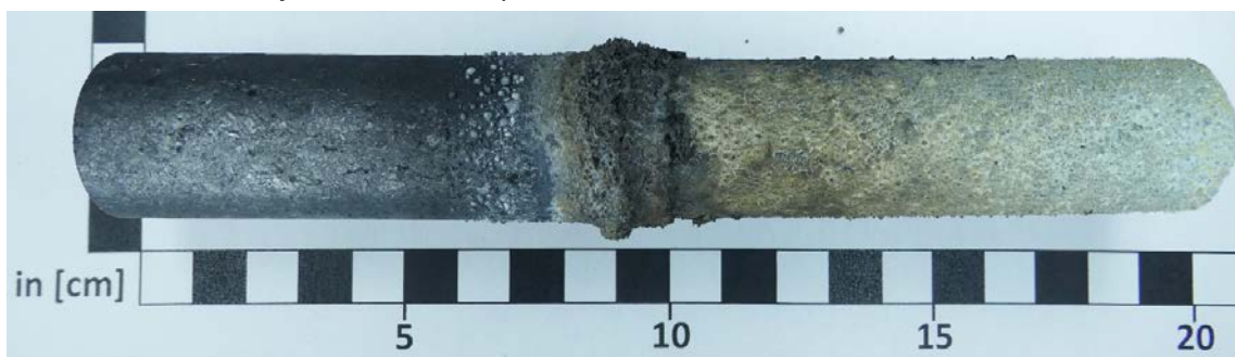
Abbildung 4.36: Probe aus dem Kathodenmaterial G2 nach einer 24-stündigen Elektrolyse bei 0,4 A/cm 2 mit 1 und 24 Zyklen bei einer Amplitude von -40 °C
