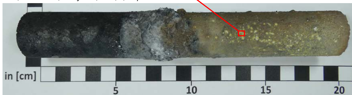
Abbildung 4.35: Proben aus dem Werkstoff A1 nach einer 24-stündigen Elektrolyse bei 0,4 A/cm 2 mit 24 Zyklen bei einer Amplitude von -40 °C und 12 Zyklen bei einer Amplitude von \pm 40 °C
