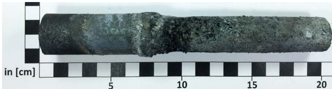
Abbildung 4.23: Verschlossene Proben aus dem Kathodenmaterial G1 nach 4 und 48 Stunden bei 960 °C und einer Stromdichte von 0,4 A/cm 2
