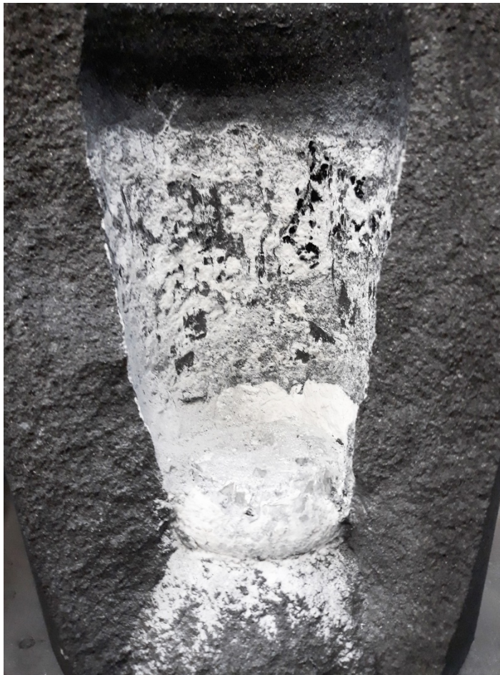
Abbildung 7.1.4: Aufgebrochener Tiegel mit tropfenförmigem Bodensatz
