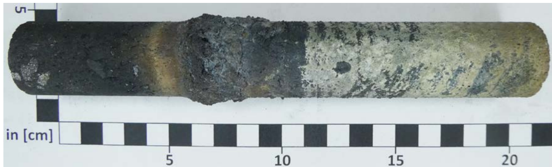
Abbildung 4.46: Proben der Werkstoffe G2 und A1 nach 1-stündiger Elektrolyse bei einer Temperatur von 960 °C und einer Stromdichte von 0,4 A/cm 2
