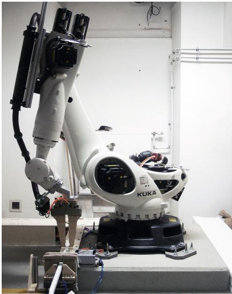
**Abb. 7 \_ Industrieroboter: KUKA KR120R2500**
