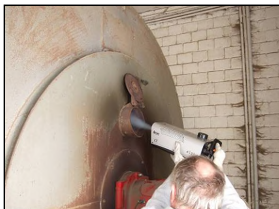
Bild D.23: Eingabe von Nebel in die Entlastungsklappe [FSA,2010]
