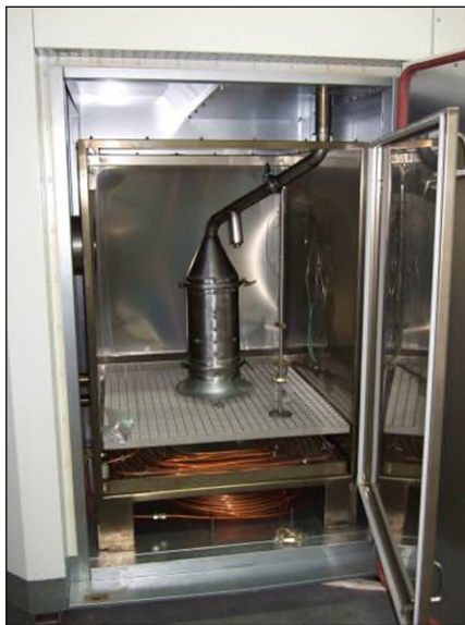
Bild B.1: Versuchseinrichtung Bild B.2: Wärmeschränk und Abluftleitungen beide [FSA,2010]
