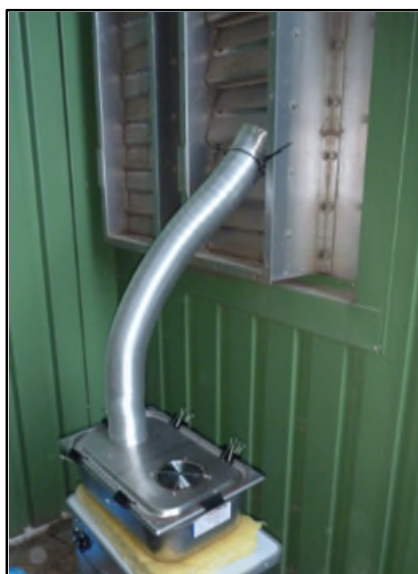
Bild D.38: Einbringung des Brandrauches in den „neuen“ Trockner in die Nebenstrom- Öffnung der Abluft-Seite [KELLETT,2014]
