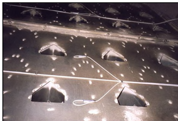
Bild 6.8: Temp.-Messstellen Abluftseite [LISTEC,2001]
