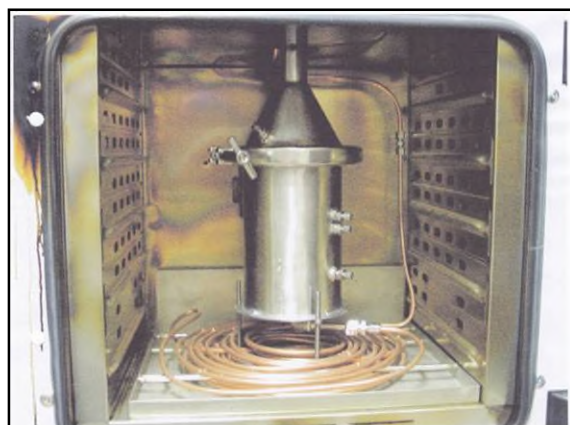
Bild D.2: Im Wärmeschrank eingebauter Versuchsbehälter [FSA,2010]
