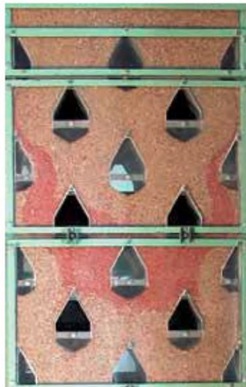
Bild 3.3: Partikelströmungsprofil gefärbter Weizenkörner in der herkömmlichen Apparategeometrie [WEIGLE,2014]
