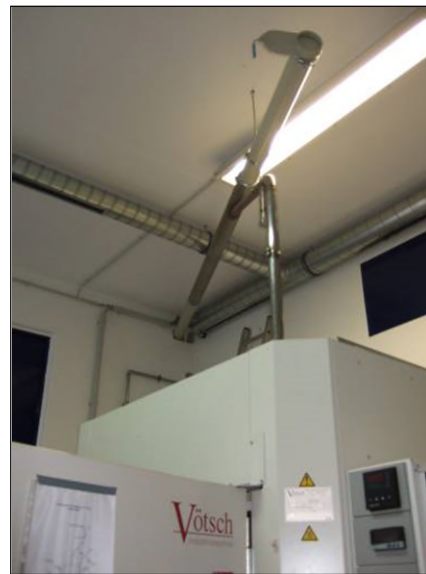
Bild B.1: Versuchseinrichtung Bild B.2: Wärmeschränk und Abluftleitungen beide [FSA,2010]
