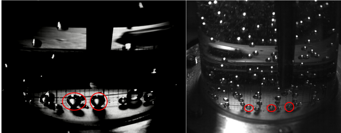
Abbildung 17: Hochgeschwindigkeitskameraaufnahme zur Ermittlung der Gasblasengröße bei einem Gasfluss von 100 \text{ mL}\cdot\text{min}^{-1} ; links: \beta_0(6:2 \text{ FTS}): 5 \text{ mg}\cdot\text{L}^{-1} in Reinstwasser; rechts: \beta_0(6:2 \text{ FTS}): 5 \text{ mg}\cdot\text{L}^{-1} in 0,2 molarer Natriumsulfatlösung
