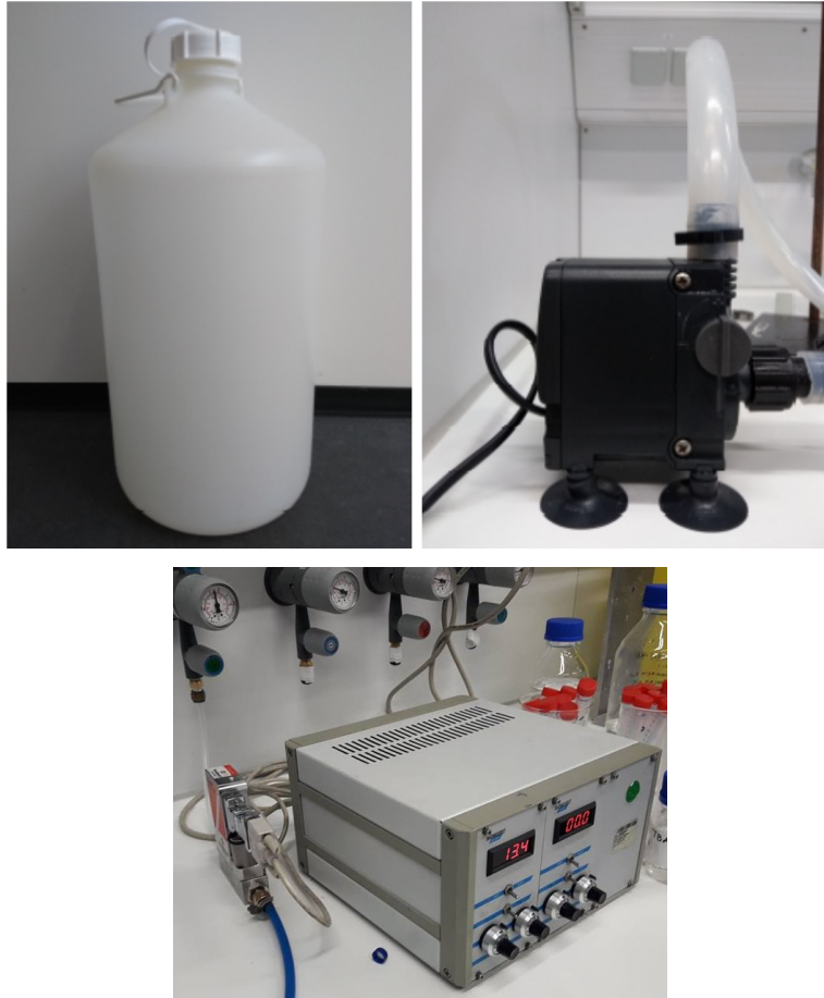
Abbildung 42: Standballon, Aquariumpumpe EHEM Compact+ 3000, EL-Flowcontroller
