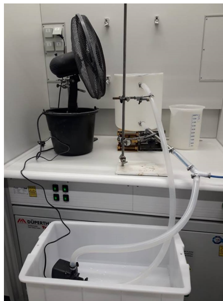
Abbildung 43: Gesamte Apparatur mit statischem Mischer zur Durchführung der ABE-Versuche
