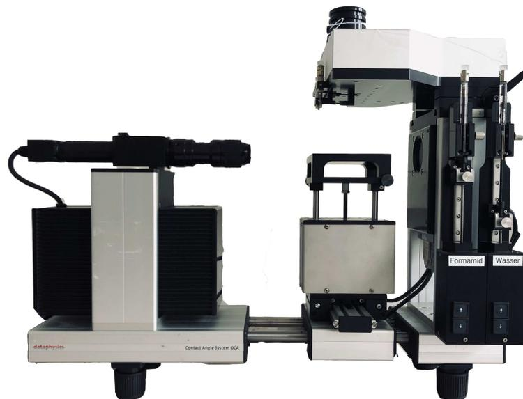
*Abbildung 5.3: OCA 20 von DataPhysics zur Kontaktwinkelmessung*
