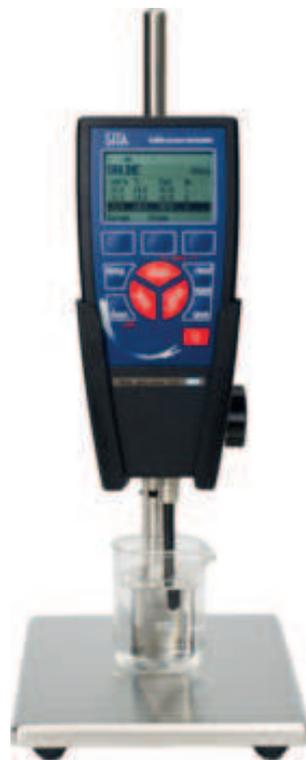
*Abbildung 5.1: Handmessgerät pro line t15 von SITA Messtechnik GmbH zur Messung der Oberflächenspannung mittels Blasendruck.*
