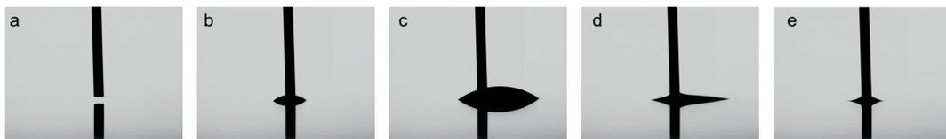
**Abbildung 5.4:** Kontaktwinkelmessung von Wasser auf Glas mittels ACRA-Messmodul zur Bestimmung der Kontaktwinkelhysterese. Die Dosiernadel wird kurz vor der Probe positioniert. Durch Zugabe und Rücknahme von Flüssigkeitsvolumen auf der Probe können ein Fortschreitwinkel und ein Rückzugswinkel an der Drei-Phasen-Kontaktlinie gemessen werden.
