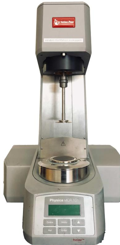
*Abbildung 5.6: Rheometer Typ MCR 101 von Anton Paar zur Messung der Viskosität*
