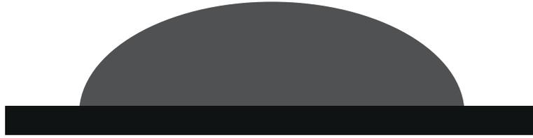
*Abbildung 3.4: Idealisiertes Dome-Profil mit relativ gleichmäßiger Schichtdickenverteilung bedingt durch die Krümmung der Oberfläche einer Flüssigkeit auf dem Substrat.*
