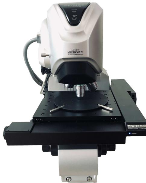
*Abbildung 5.7: 3D-Laserscanning-Mikroskop VK-X150 von Keyence zur Vermessung trocknender Oberflächen.*
