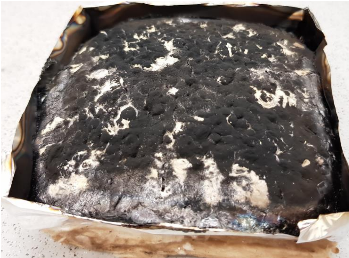
Abbildung A.5: Rückstand von flammgeschützten PA 6.6 nach Cone-Kalorimeterversuchen mit 35 kW/m 2 Wärmestromdichte
