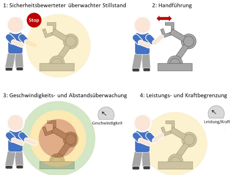
Abbildung 9: Schutzprinzipien für die MRK nach DIN/ISO TS 15066.
