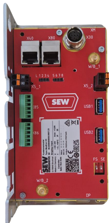
Abbildung 52: Hardwareausführung der Compound-SPS.
