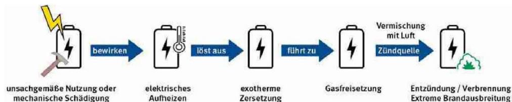
Abbildung 1: Brandverhalten von Lithium-Ionen-Batterien (DGUV e. V. 2020b)
