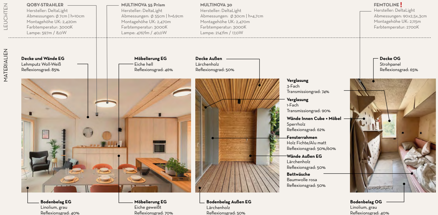
Abbildung 1: Innenräume und lichttechnische Eigenschaften für das FHA-Gebäude
