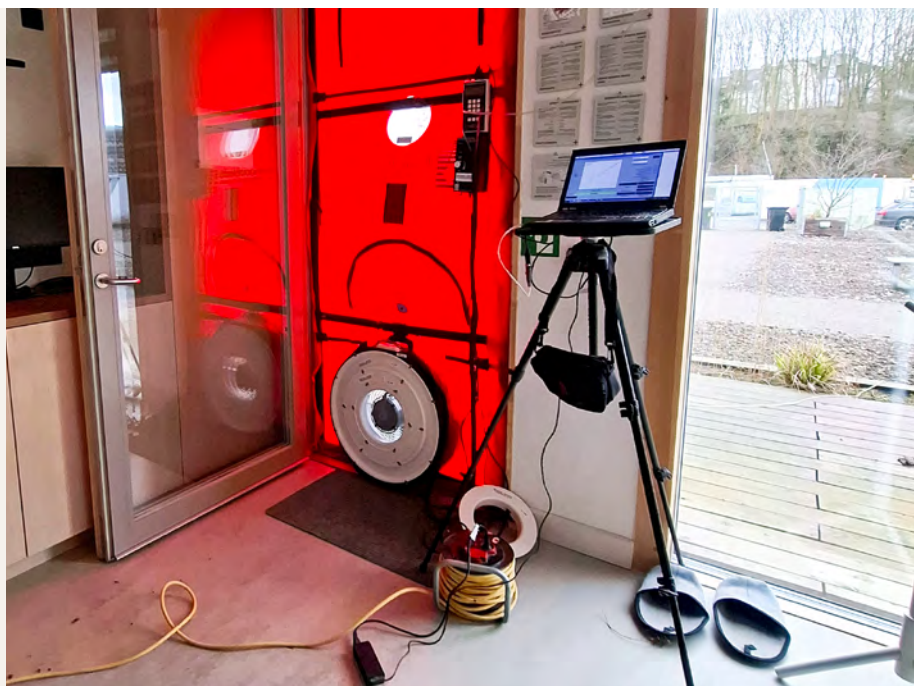
Abbildung 1: Blower Door in eingebautem Zustand.
