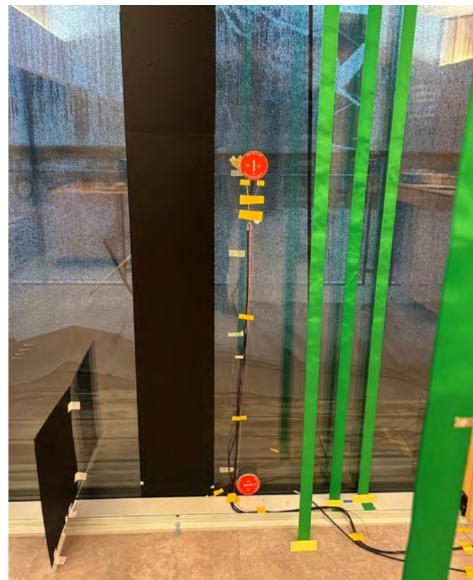
Abbildung 1: Raumseitiger Blick auf die Messanordnung mit Wärmeflussdichtemessplatten (rote Kreise), verschatteter und abgeklebter Glasfläche und grünen Stoffstreifen zur Sichtbarmachung der Lufttemperaturen über die Raumhöhe © CTU Prag
