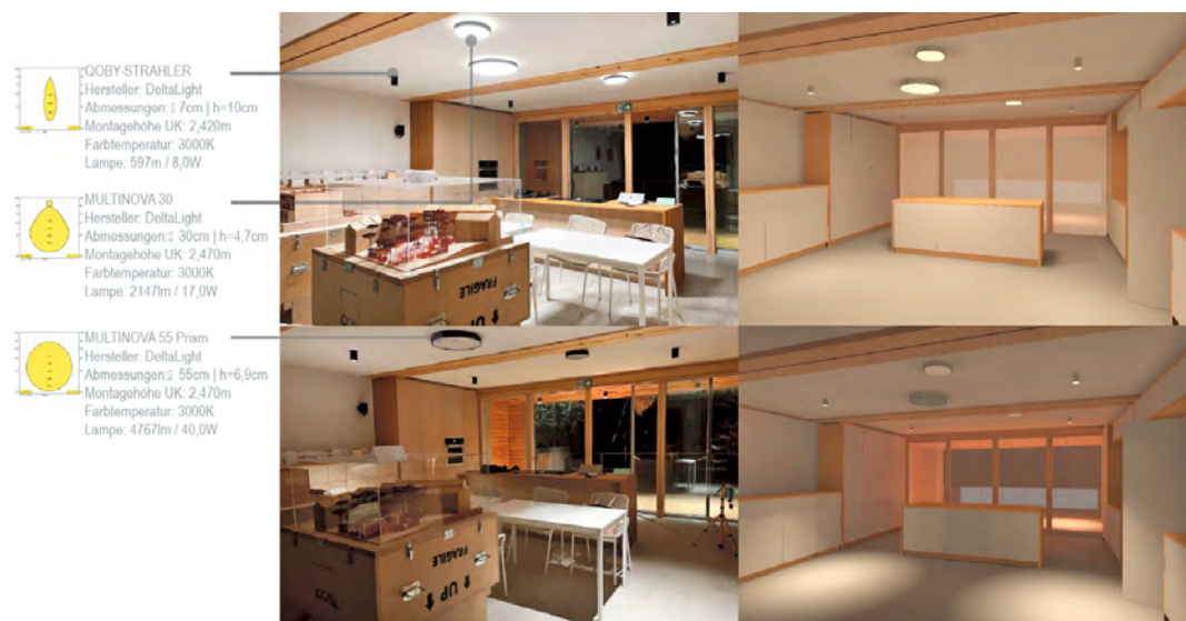
Abbildung 4: Vergleich der Atmosphären bei unterschiedlicher künstlicher Beleuchtung in der Realität (links) und der Simulation (rechts, ohne die zusätzlichen Einrichtungsgegenstände).
