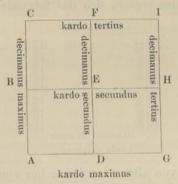
Die Schnittpunkte werden bezeichnet mit den Benennungen der beiden sich schneidenden Linien, und zwar so, dass diese entweder auf der Oberfläche <sup>2</sup> in verschiedener Richtung vermerkt oder auf
